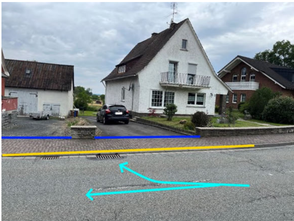
Abbildung 74: Notfließweg "Betzdorfer Straße" mit Fließrichtung (hellblau), Objektschutzmaßnahmen (blau) und Bordanlagen (gelb)
