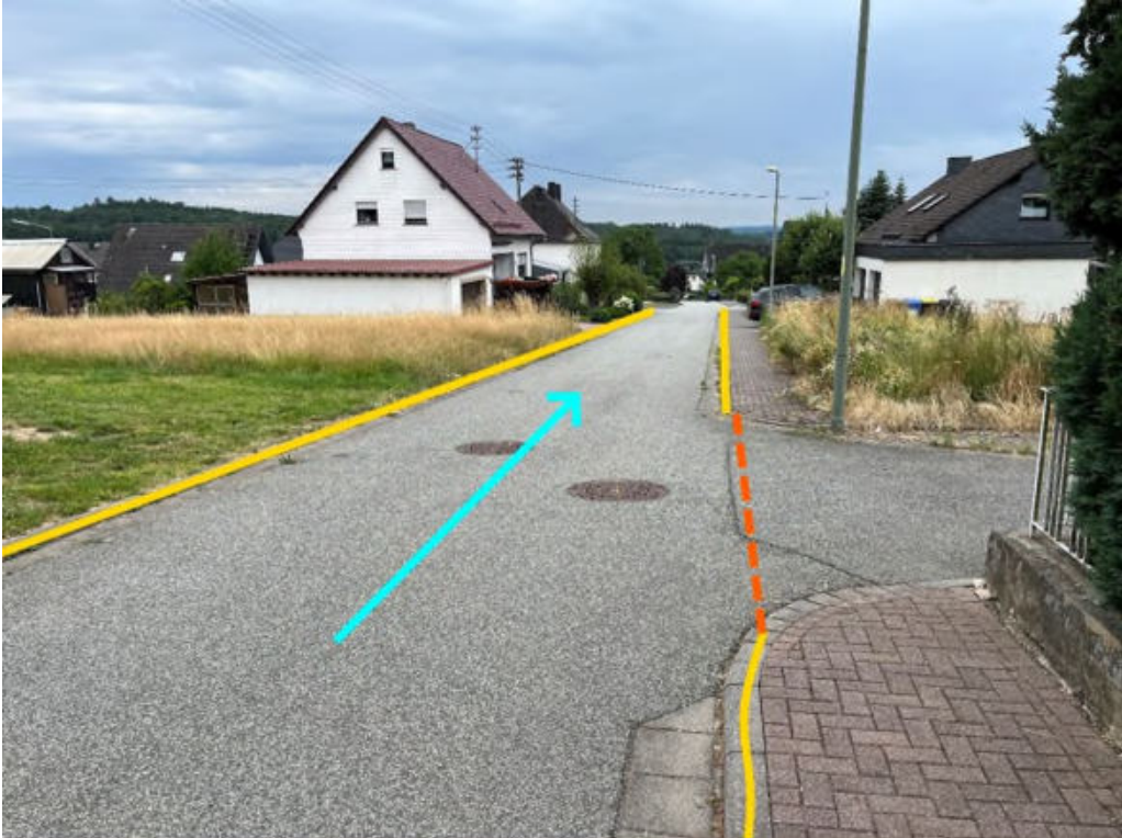
Abbildung 101: Notfließweg „Laystraße“ mit Fließrichtung (hellblau), Aufwallung (orange) Bordanlagen (gelb)
