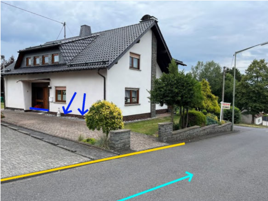
Abbildung 92: Notfließweg "Im Kochbrunnen" mit Fließrichtung (hellblau), Objektschutzmaßnahmen (blau) und Bordanlagen (gelb)
