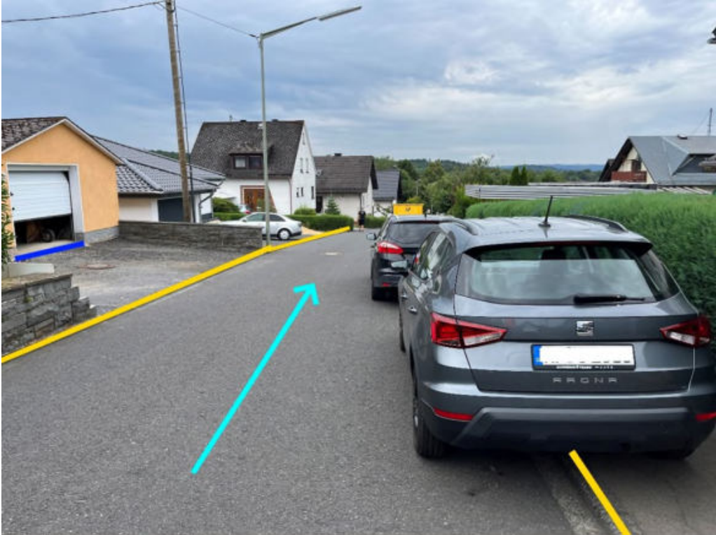
Abbildung 85: Notfließweg "Im Kochbrunnen" mit Fließrichtung (hellblau), Objektschutzmaßnahmen (blau) und Bordanlagen (gelb)
