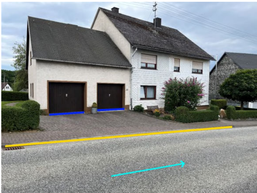
Abbildung 52: Notfließweg "Betzdorfer Straße" mit Fließrichtung (hellblau), Objektschutzmaßnahmen (blau) und Bordanlagen (gelb)
