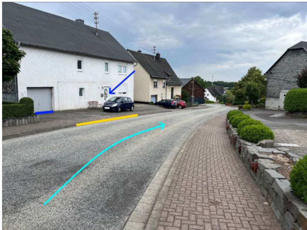
Abbildung 53: Notfließweg "Betzdorfer Straße" mit Fließrichtung (hellblau), Objektschutzmaßnahmen (blau) und Bordanlagen (gelb)
