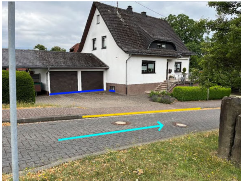
Abbildung 63: Notfließweg "Betzdorfer Straße" mit Fließrichtung (hellblau), Objektschutzmaßnahmen (blau) und Bordanlagen (gelb)
