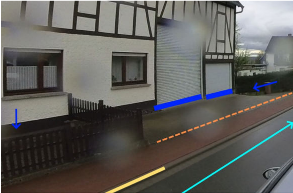
Abbildung 153: Notfließweg „Bergstraße" mit Fließrichtung (hellblau) und Objektschutzmaßnahmen (blau), Aufwallung (orange) und Bordanlagen (gelb)
