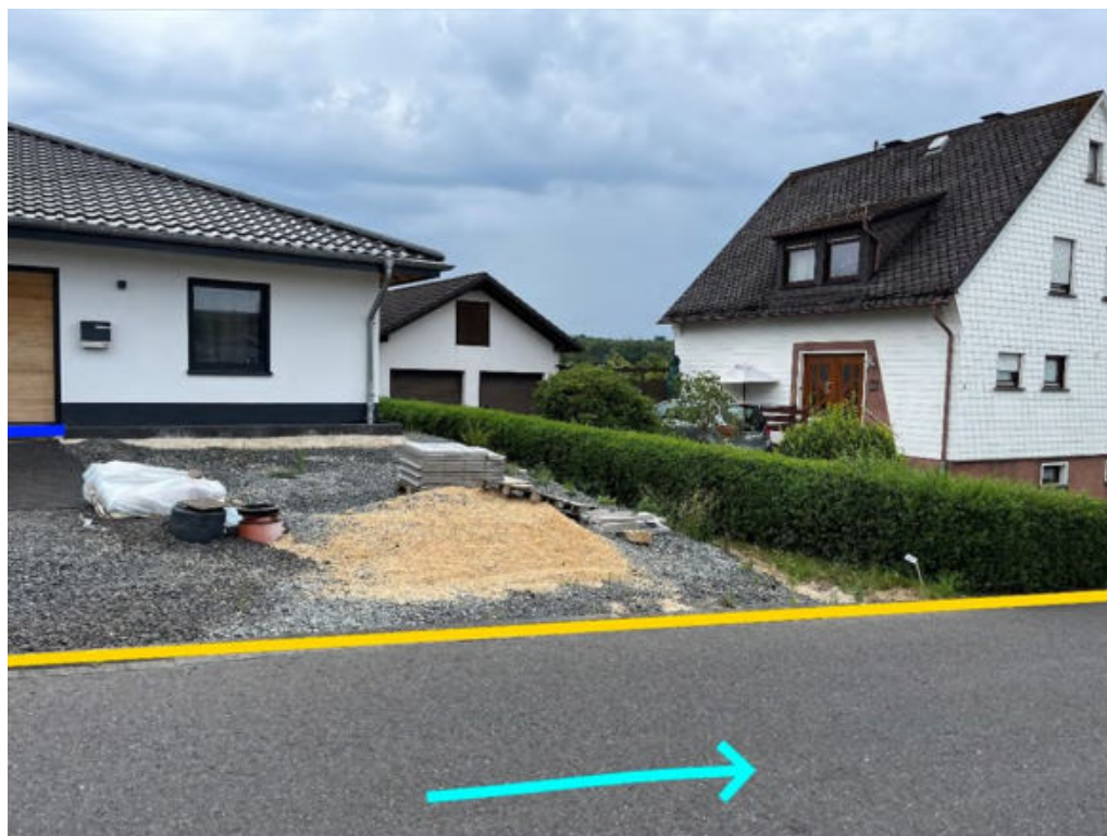
Abbildung 88: Notfließweg "Im Kochbrunnen" mit Fließrichtung (hellblau), Objektschutzmaßnahmen (blau) und Bordanlagen (gelb)
