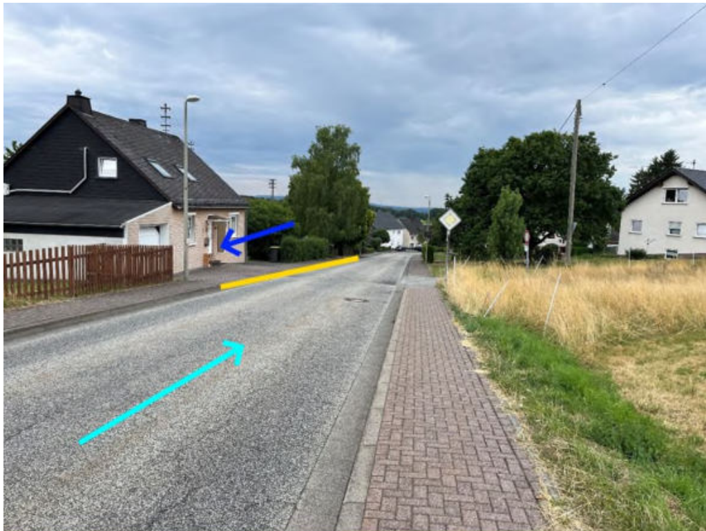
Abbildung 45: Notfließweg "Betzdorfer Straße" mit Fließrichtung (hellblau), Objektschutzmaßnahmen (blau) und Bordanlagen (gelb)
