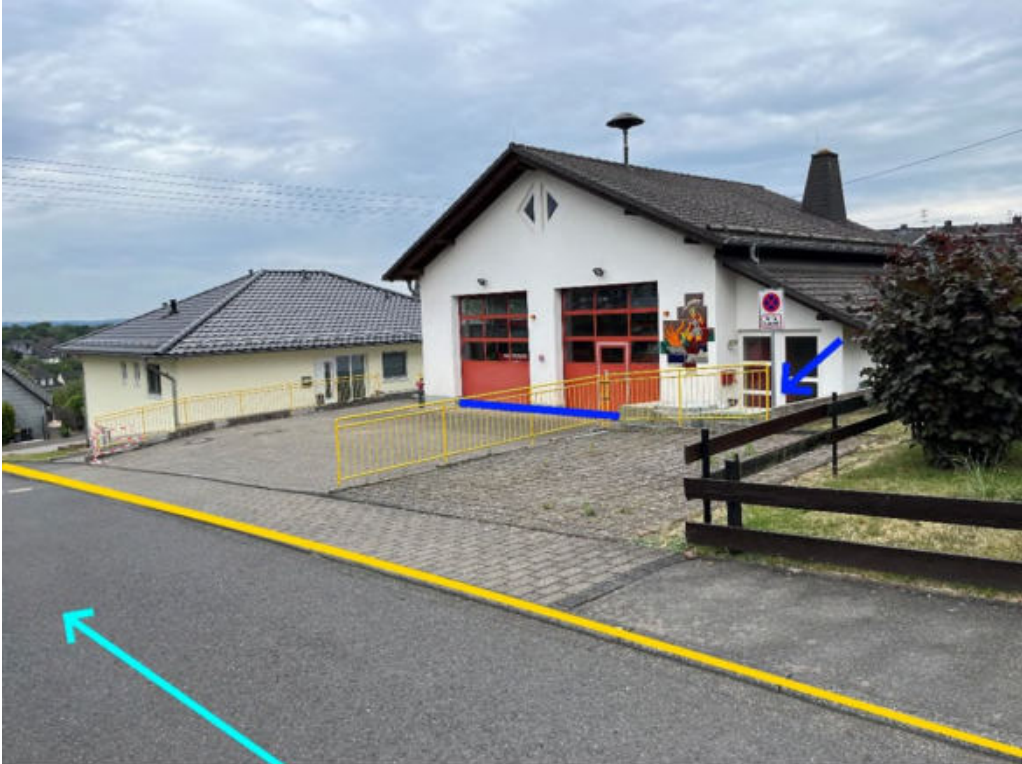
Abbildung 93: Notfließweg "Im Kochbrunnen" mit Fließrichtung (hellblau), Objektschutzmaßnahmen (blau) und Bordanlagen (gelb)
