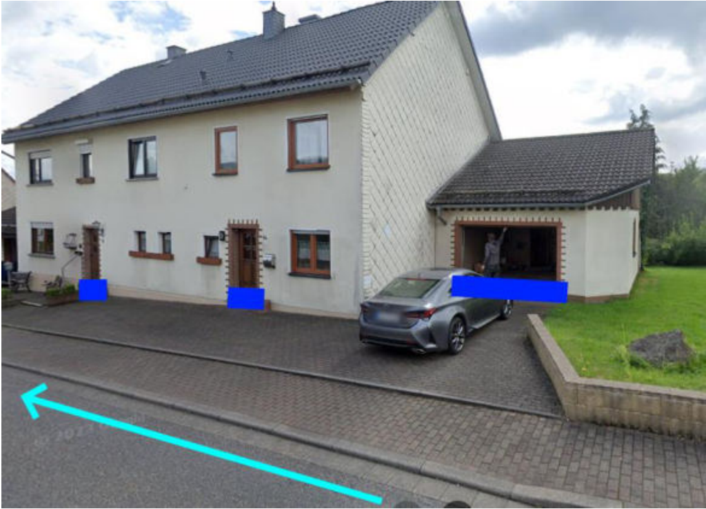
Abbildung 48: Notabflussweg "Bad Marienberger Straße" mit Fließrichtung (hellblau) und Objektschutzmaßnahmen (dunkelblau)
