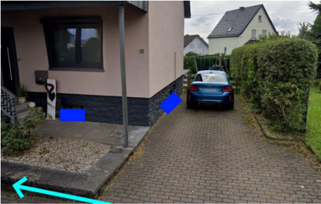
Abbildung 53: Notabflussweg "Bad Marienberger Straße" mit Fließrichtung (hellblau) und Objektschutzmaßnahmen (dunkelblau)
