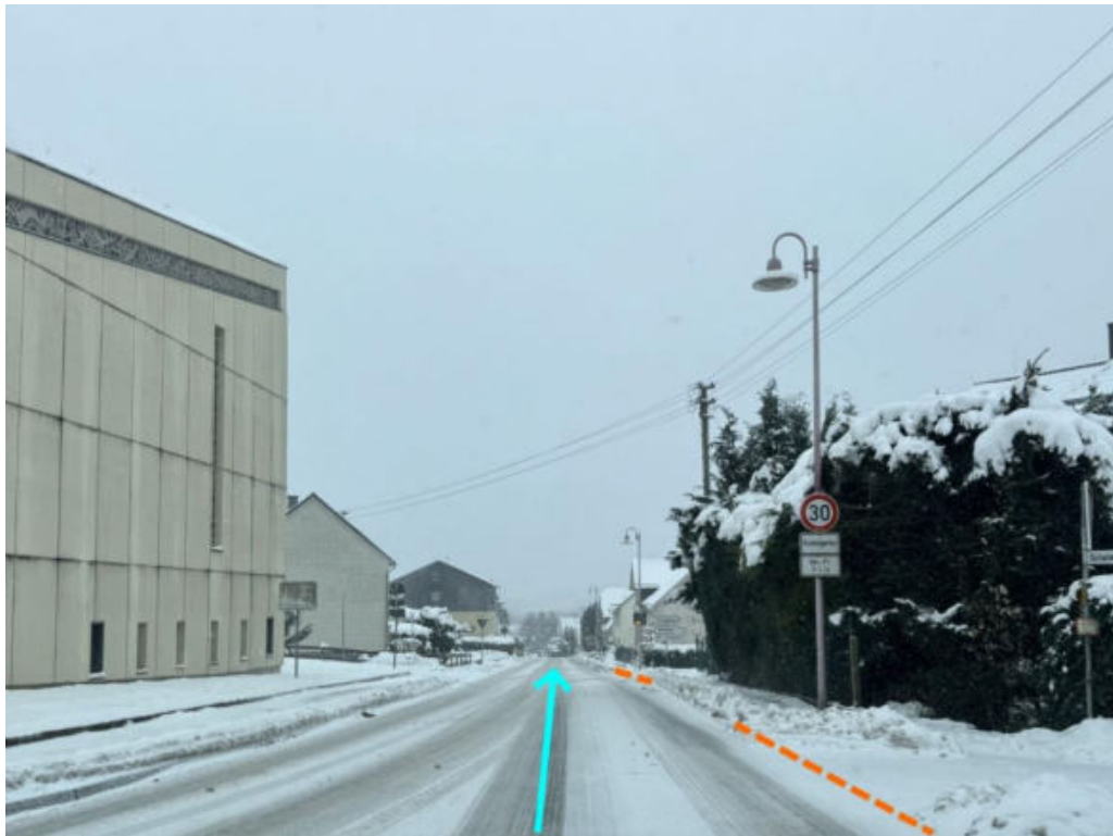
Abbildung 39: Notabflussweg "Bad Marienberger Straße" mit Fließrichtung (hellblau), Objektschutzmaßnahme (dunkelblau) und Bordanlage (gelb)
