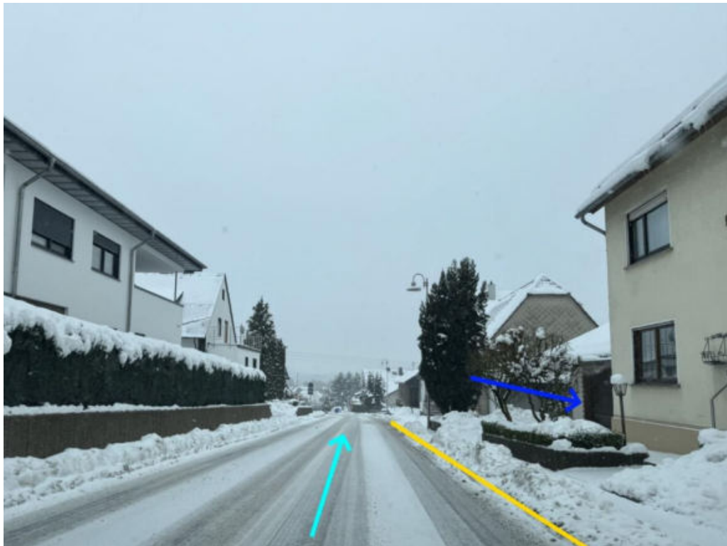
Abbildung 41: Notabflussweg "Bad Marienberger Straße" mit Fließrichtung (hellblau), Objektschutzmaßnahme (dunkelblau) und Bordanlage (gelb)
