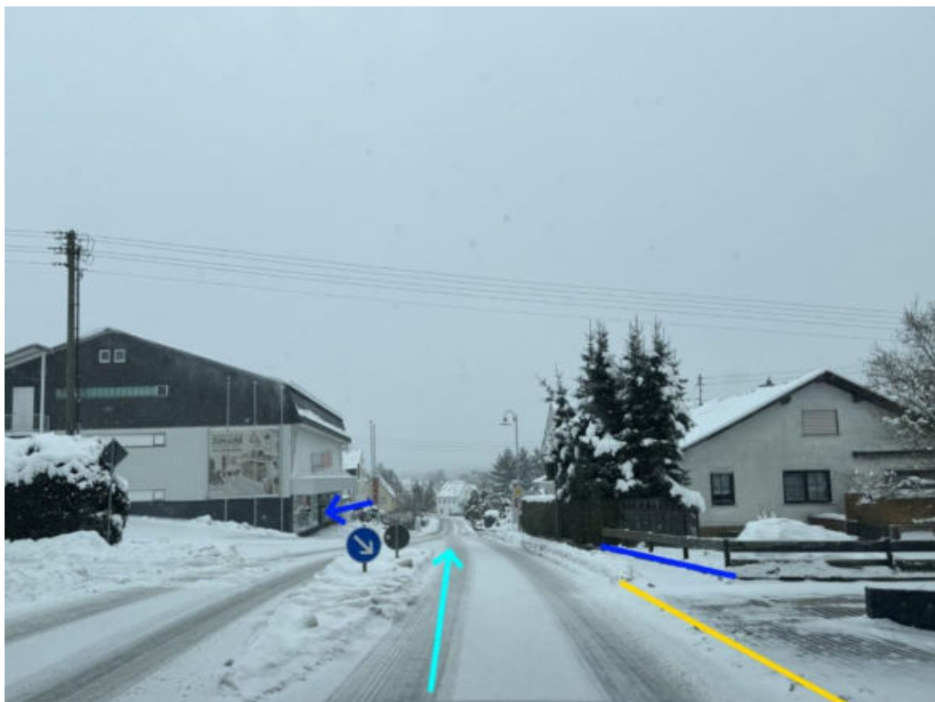
Abbildung 42: Notabflussweg "Bad Marienberger Straße" mit Fließrichtung (hellblau), Objektschutzmaßnahme (dunkelblau) und Bordanlage (gelb)
