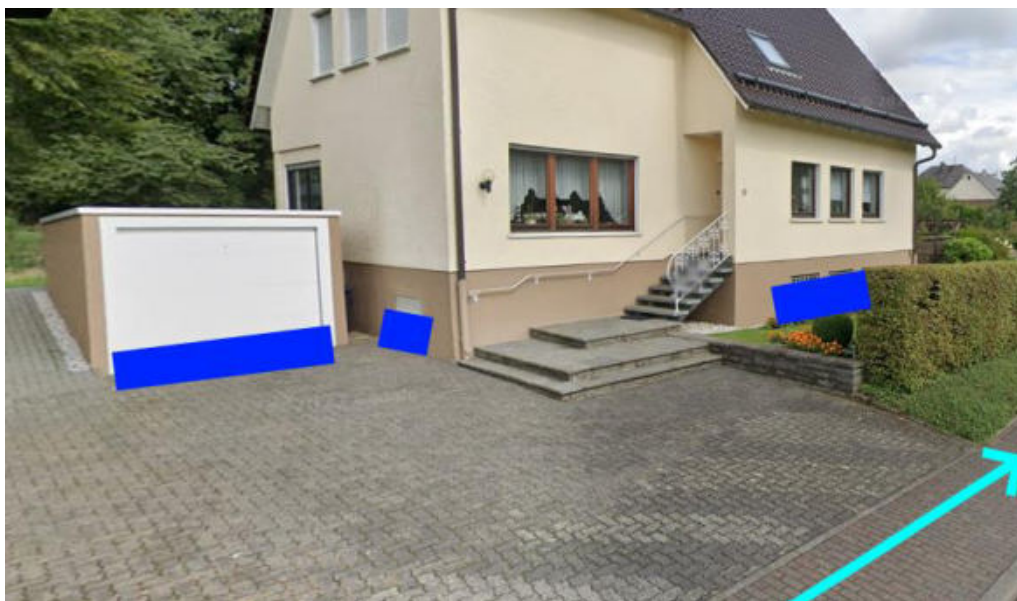
Abbildung 59: Notabflussweg "Bad Marienberger Straße" mit Fließrichtung (hellblau) und Objektschutzmaßnahmen (dunkelblau)
