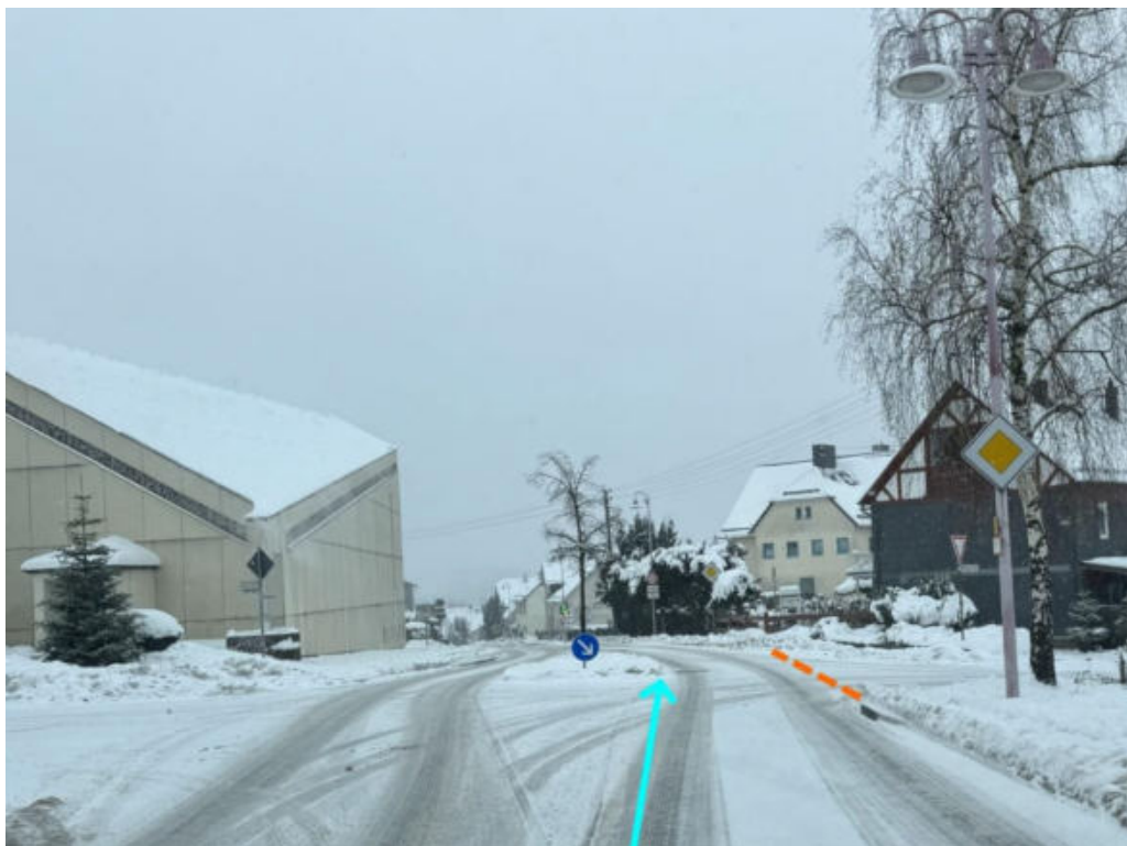
Abbildung 38: Notabflussweg "Bad Marienberger Straße" mit Fließrichtung (hellblau), Objektschutzmaßnahme (dunkelblau) und Bordanlage (gelb)
