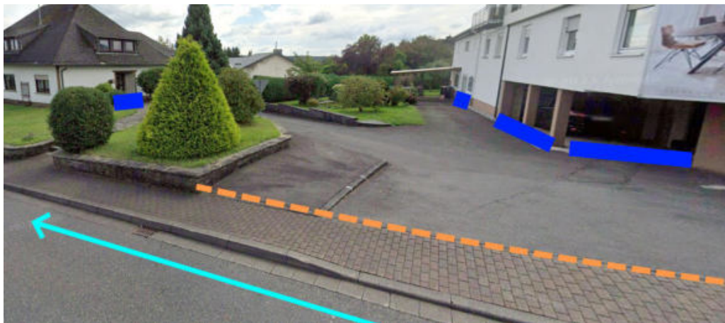
Abbildung 56: Notabflussweg "Bad Marienberger Straße" mit Fließrichtung (hellblau), Objektschutzmaßnahmen (dunkelblau) und Aufwallung (orange)
