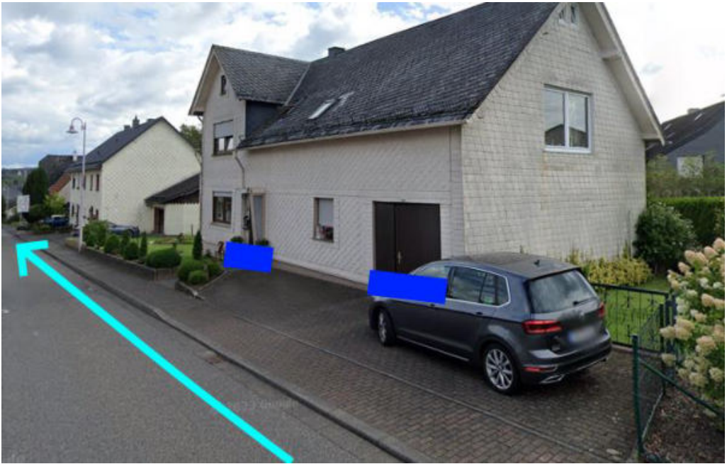
Abbildung 46: Notabflussweg "Bad Marienberger Straße" mit Fließrichtung (hellblau), Objektschutzmaßnahme (dunkelblau) und Bordanlage (gelb)
