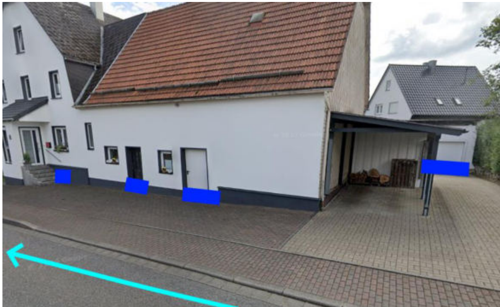
Abbildung 49: Notabflussweg "Bad Marienberger Straße" mit Fließrichtung (hellblau) und Objektschutzmaßnahmen (dunkelblau)
