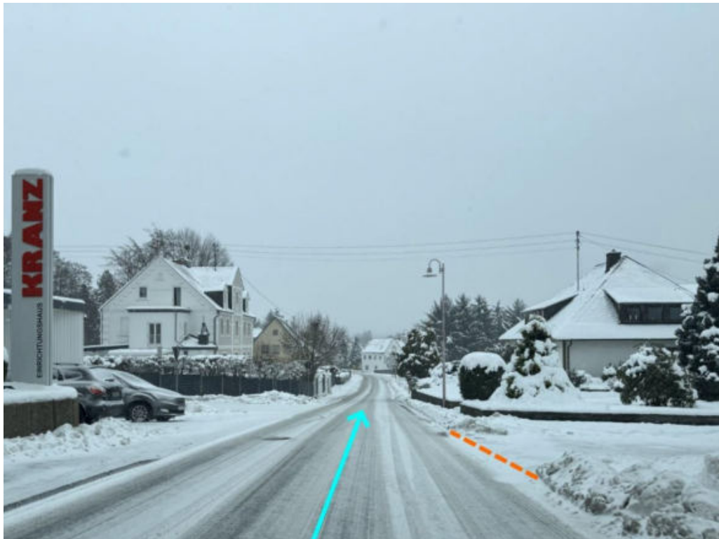
Abbildung 43: Notabflussweg "Bad Marienberger Straße" mit Fließrichtung (hellblau), Objektschutzmaßnahme (dunkelblau) und Bordanlage (gelb)
