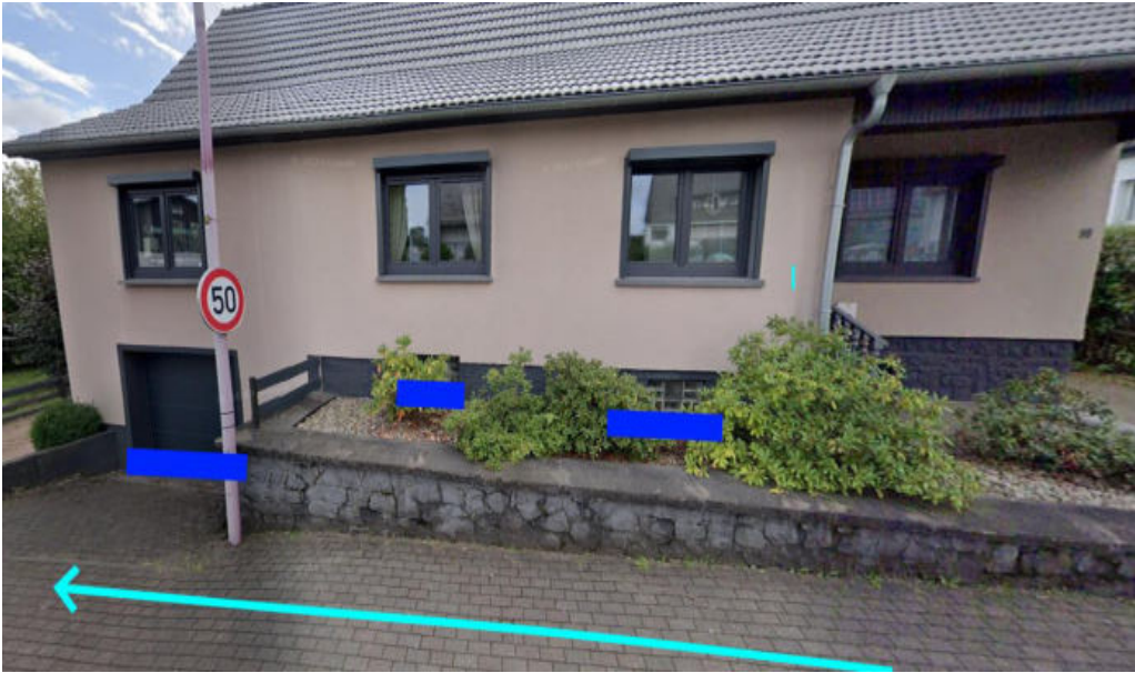
Abbildung 52: Notabflussweg "Bad Marienberger Straße" mit Fließrichtung (hellblau) und Objektschutzmaßnahmen (dunkelblau)
