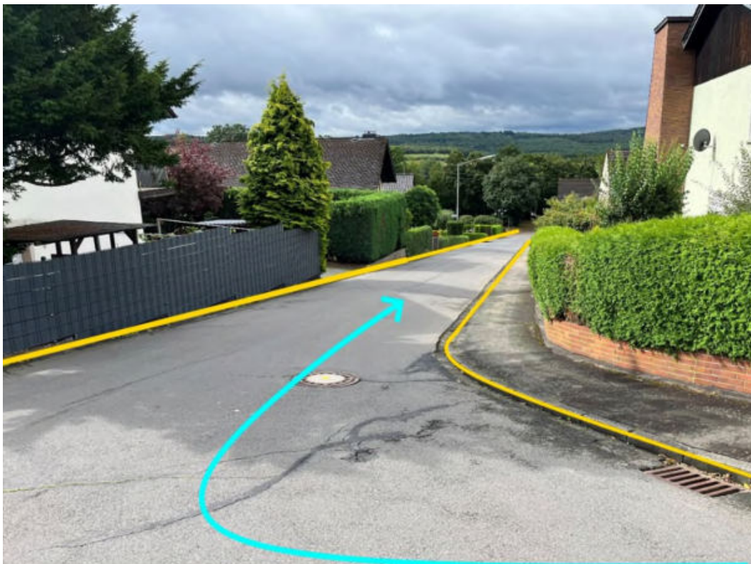
Abbildung 130: Notabflussweg "Lärchenweg" mit Fließrichtung (hellblau) und Bordanlagen (gelb)
