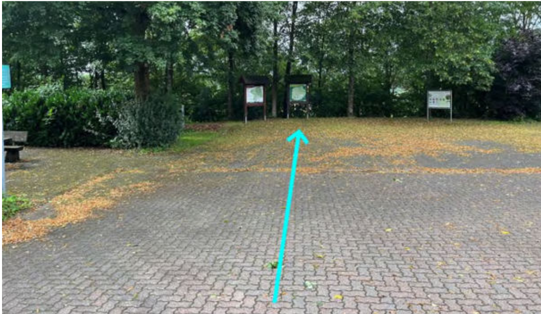
Abbildung 138: Notabflussweg "Schulstraße" mit Fließrichtung (hellblau)
