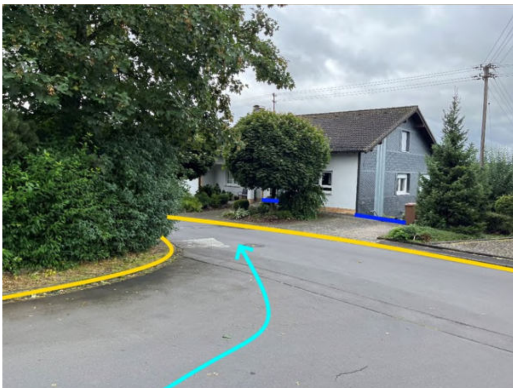
Abbildung 112: Notabflussweg "Auf der Höhe" mit Fließrichtung (hellblau), Objektschutzmaßnahmen (blau) und Bordanlagen (gelb)
