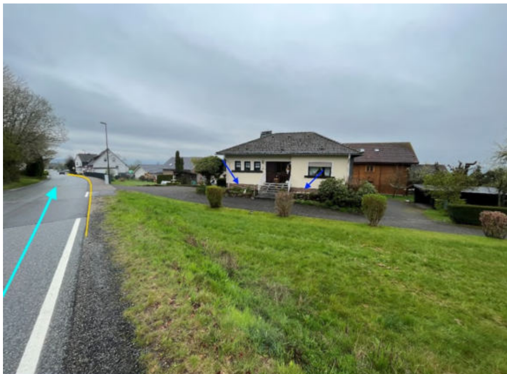
Abbildung 27: Notabflussweg "Bindweider Straße" mit Fließrichtung (hellblau), Objektschutzmaßnahmen (dunkelblau) und Bordanlagen (gelb)
