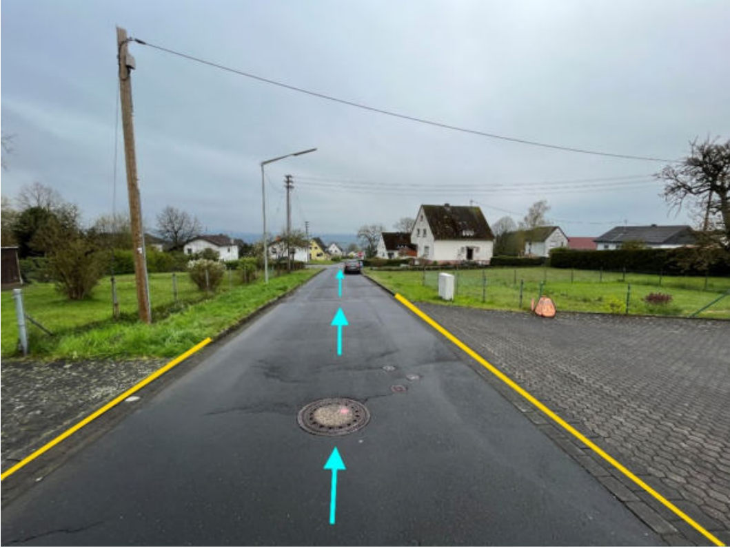
Abbildung 96: Notabflussweg "Schulstraße" mit Fließrichtung (hellblau) und Bordanlagen (gelb)
