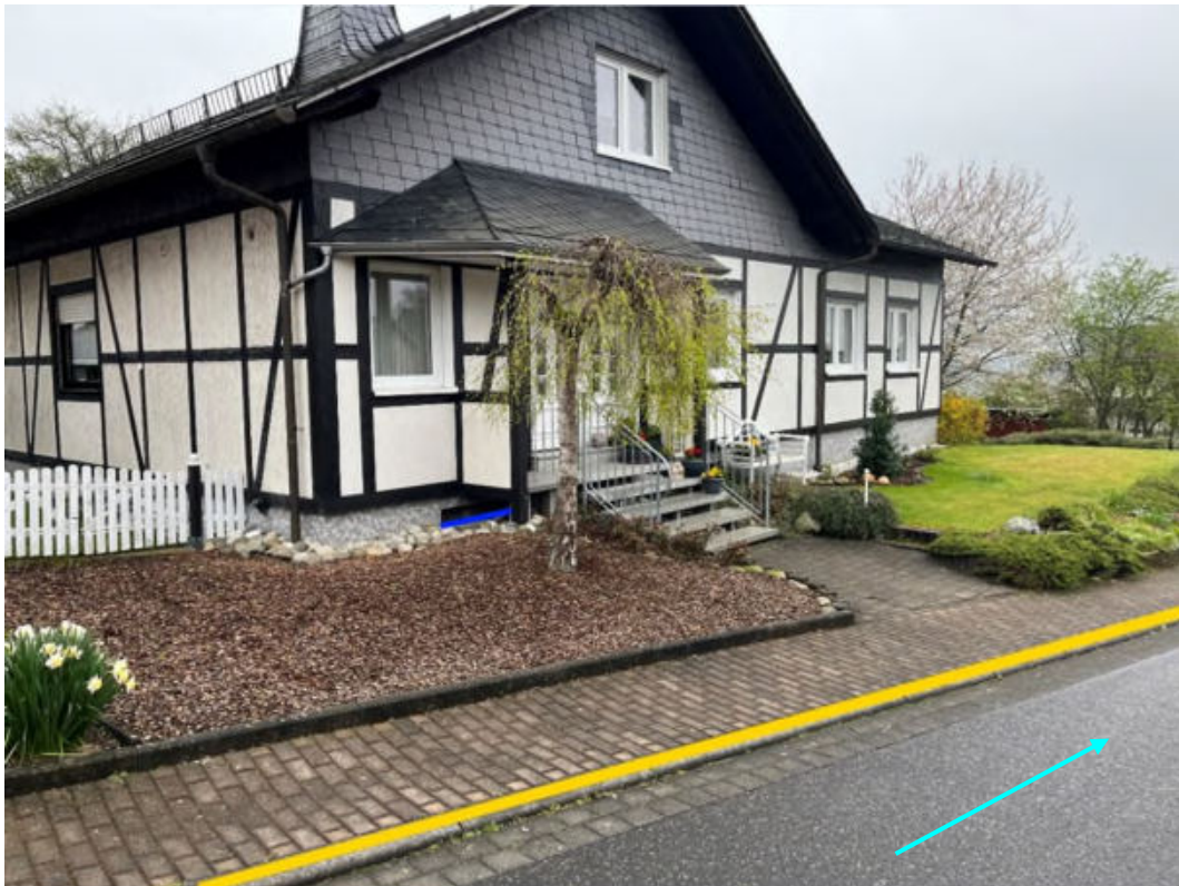
Abbildung 235: Notabflussweg "Limbacher Straße" mit Fließrichtung (hellblau), Objektschutzmaßnahmen (dunkelblau) und Bordanlagen (gelb)
