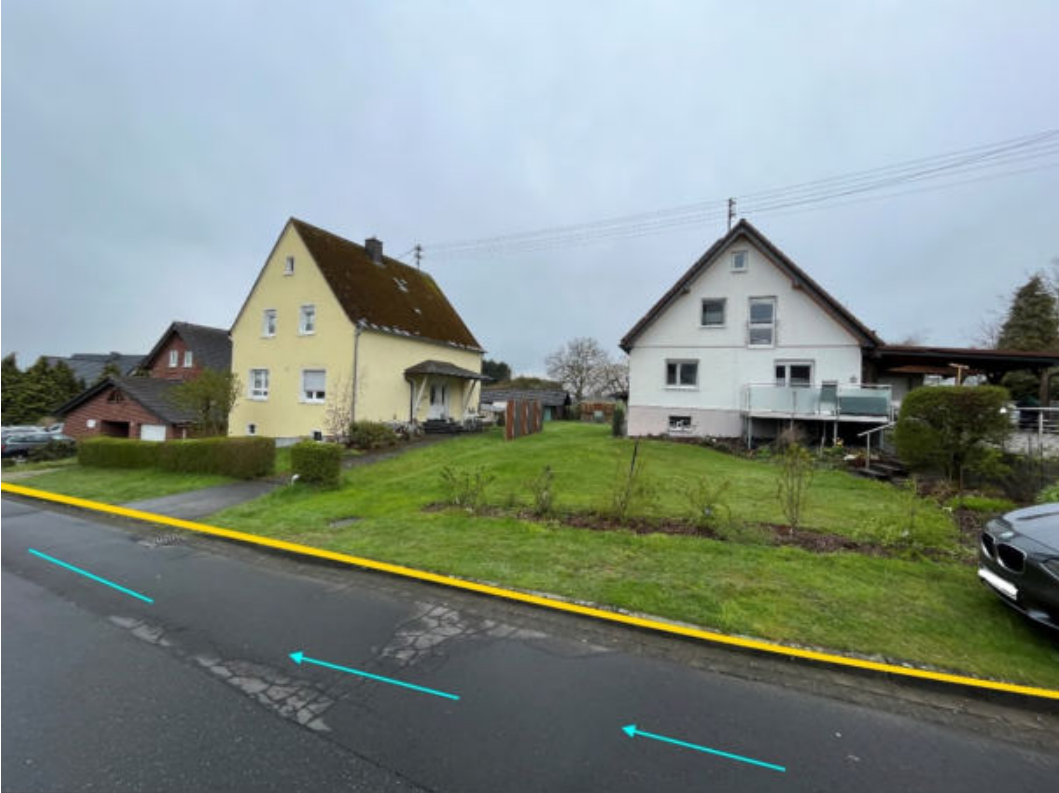
Abbildung 102: Notabflussweg "Schulstraße" mit Fließrichtung (hellblau) und Bordanlagen (gelb)
