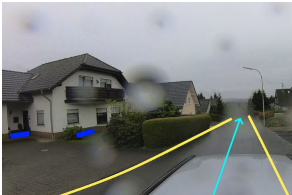
Abbildung 268: Notabflussweg "Südhang" mit Fließrichtung (hellblau), Objektschutzmaßnahmen (dunkelblau) und Bordanlagen (gelb)
