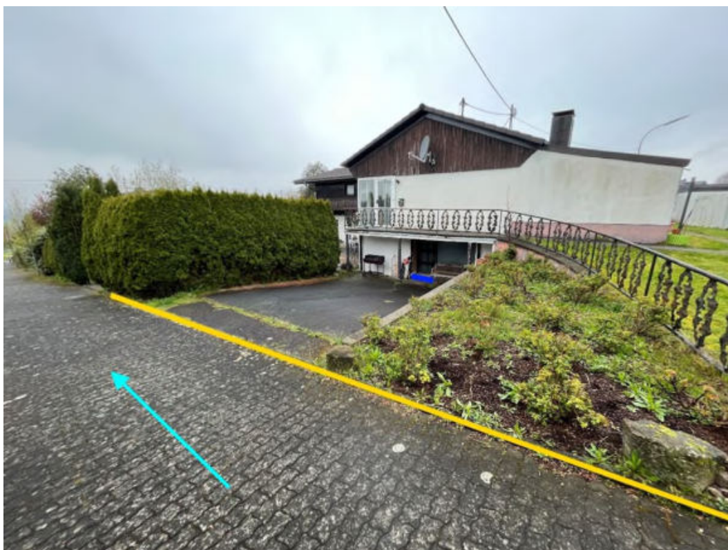
Abbildung 196: Notabflussweg "Rosenweg" mit Fließrichtung (hellblau), Objektschutzmaßnahmen (dunkelblau) und Bordanlagen (gelb)
