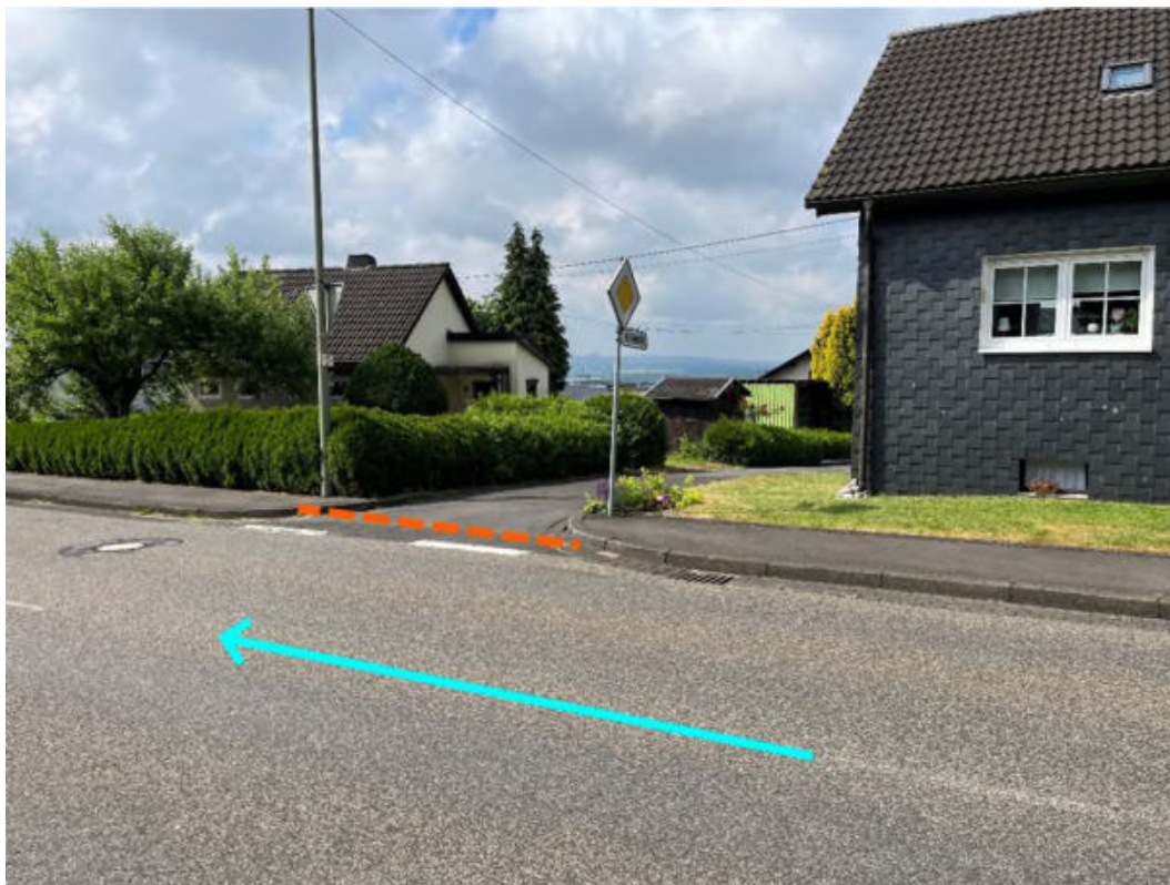
Abbildung 66: Notabflussweg „Hachenburger Straße“ mit Fließrichtung (hellblau) und Aufwallung (orange)
