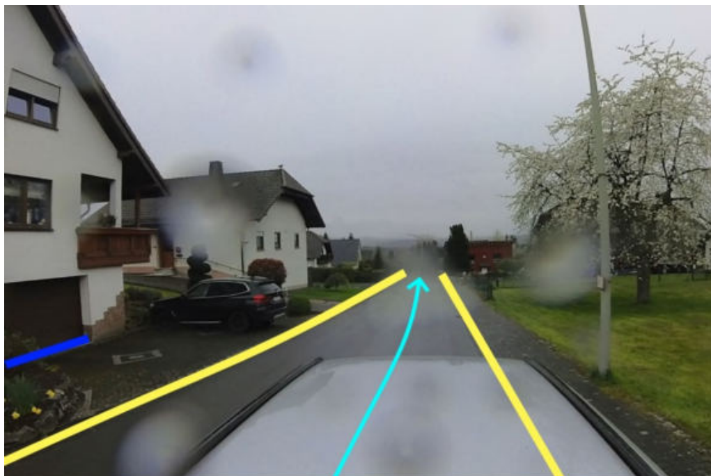
Abbildung 266: Notabflussweg "Südhang" mit Fließrichtung (hellblau), Objektschutzmaßnahmen (dunkelblau) und Bordanlagen (gelb)
