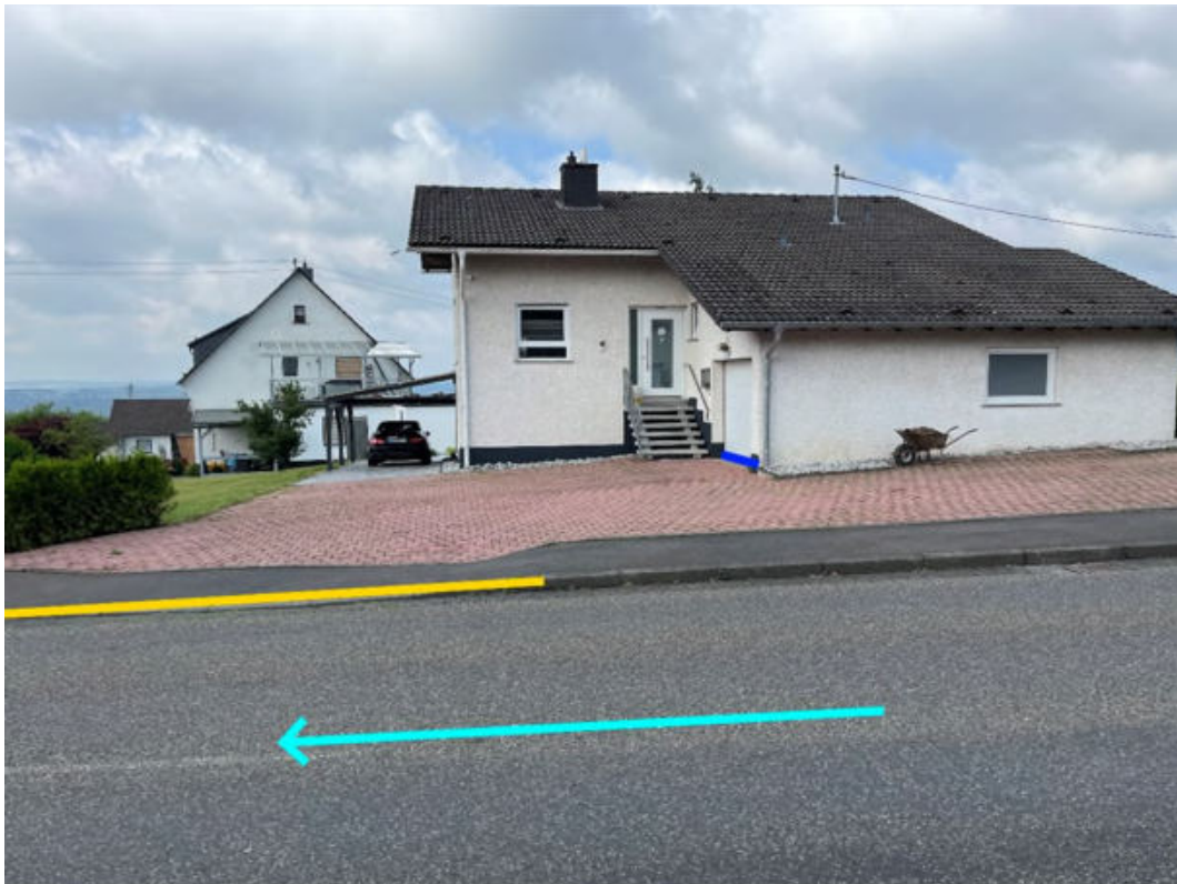
Abbildung 68: Notabflussweg „Hachenburger Straße“ mit Fließrichtung (hellblau) und Bordanlagen (gelb)
