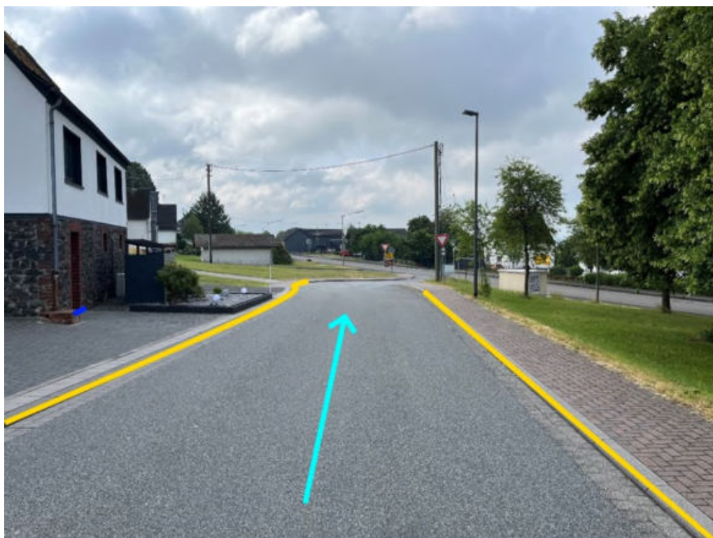
Abbildung 43: Notabflussweg „Bindweider Straße“ mit Fließrichtung (hellblau), Objektschutzmaßnahmen (dunkelblau) und Bordanlagen (gelb)
