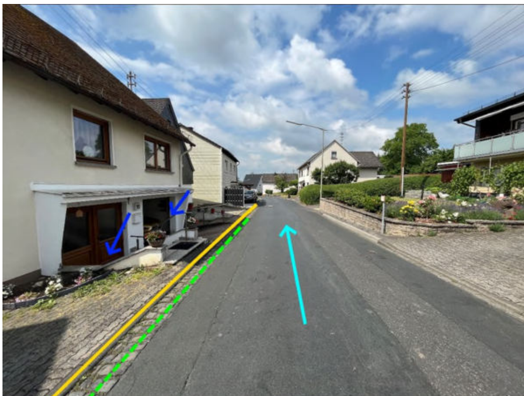
Abbildung 164: Notabflussweg "Hauptstraße" mit Fließrichtung (hellblau), Objektschutzmaßnahmen (dunkelblau), Instandsetzung der Entwässerungseinrichtung (hellgrün) und Bordanlagen (gelb)
