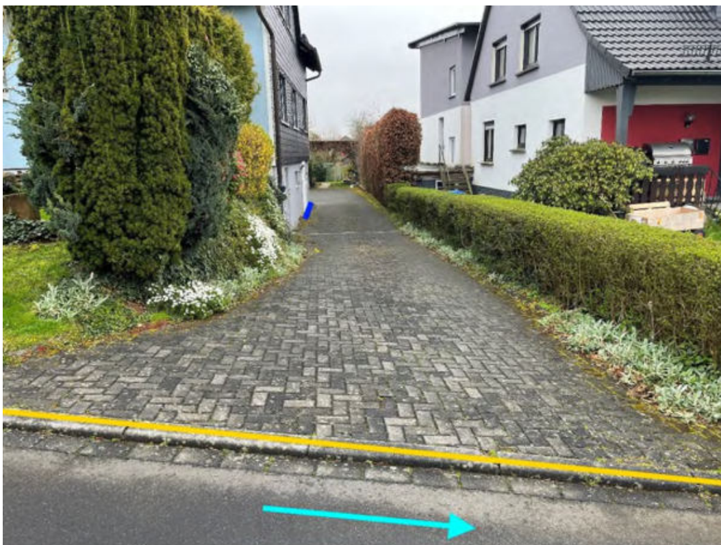
Abbildung 188: Notabflussweg "Rosenweg" mit Fließrichtung (hellblau), Objektschutzmaßnahmen (dunkelblau) und Bordanlagen (gelb)
