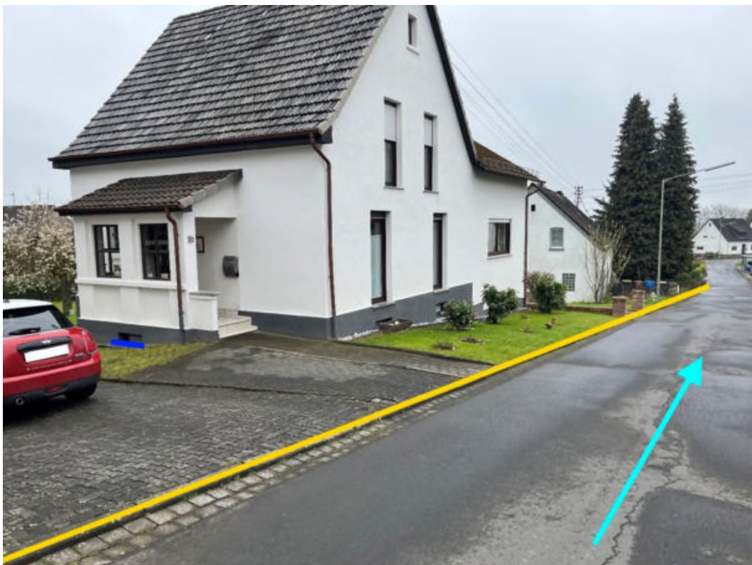
Abbildung 238: Notabflussweg "Limbacher Straße" mit Fließrichtung (hellblau), Objektschutzmaßnahmen (dunkelblau) und Bordanlagen (gelb)
