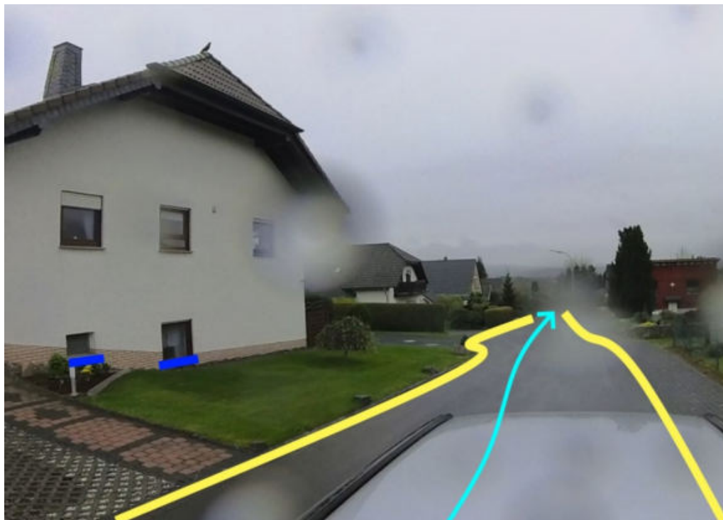
Abbildung 267: Notabflussweg "Südhang" mit Fließrichtung (hellblau), Objektschutzmaßnahmen (dunkelblau) und Bordanlagen (gelb)
