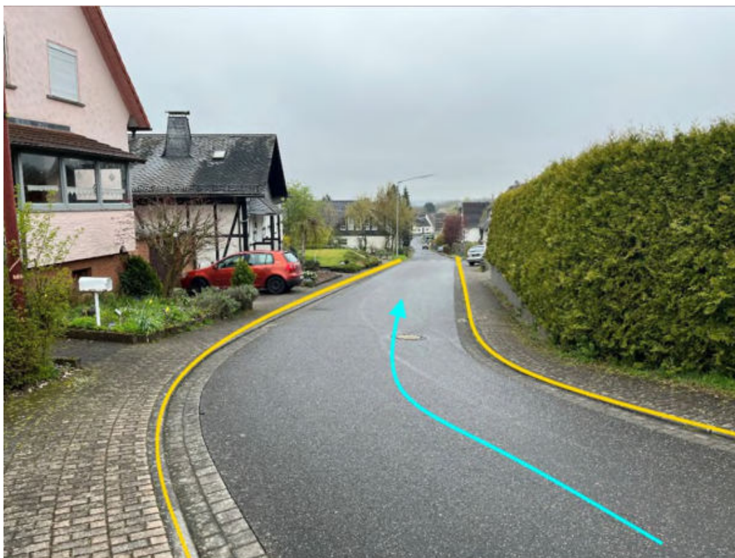
Abbildung 232: Notabflussweg " Limbacher Straße " mit Fließrichtung (hellblau) und Bordanlagen (gelb)
