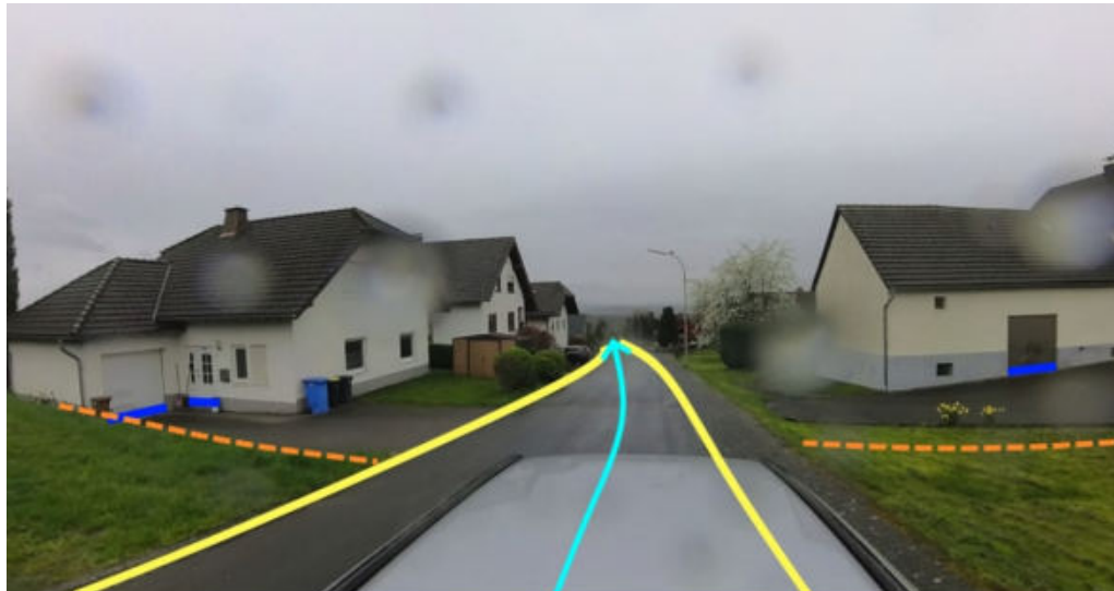
Abbildung 265: Notabflussweg "Südhang" mit Fließrichtung (hellblau), Objektschutzmaßnahmen (dunkelblau), Aufwallung (orange) und Bordanlagen (gelb)
