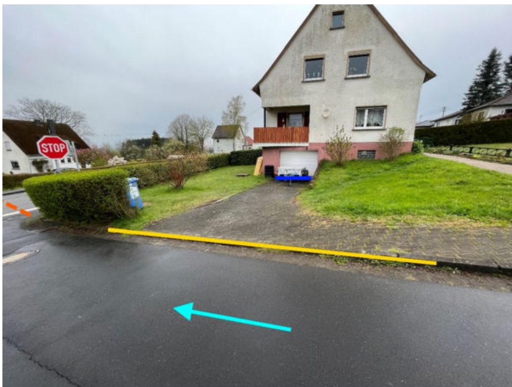
Abbildung 98: Notabflussweg "Schulstraße" mit Fließrichtung (hellblau), Objektschutzmaßnahmen (dunkelblau), Aufwallung (orange) und Bordanlagen (gelb)
