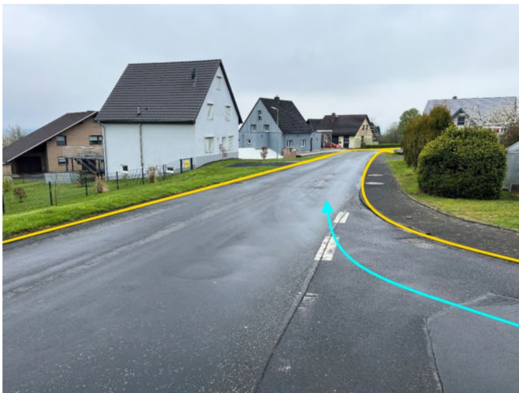
Abbildung 117: Notabflussweg "Schulstraße" mit Fließrichtung (hellblau) und Bordanlagen (gelb)
