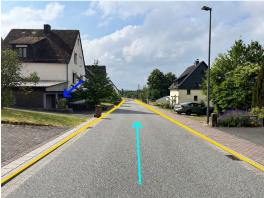
Abbildung 38: Notabflussweg „Bindweider Straße“ mit Fließrichtung (hellblau), Objektschutzmaßnahmen (dunkelblau) und Bordanlagen (gelb)
