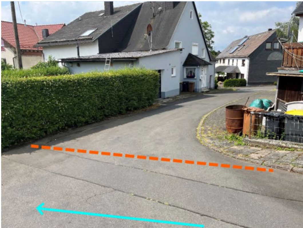
Abbildung 174: Notabflussweg "Hauptstraße" mit Fließrichtung (hellblau) und Aufwallung (orange)
