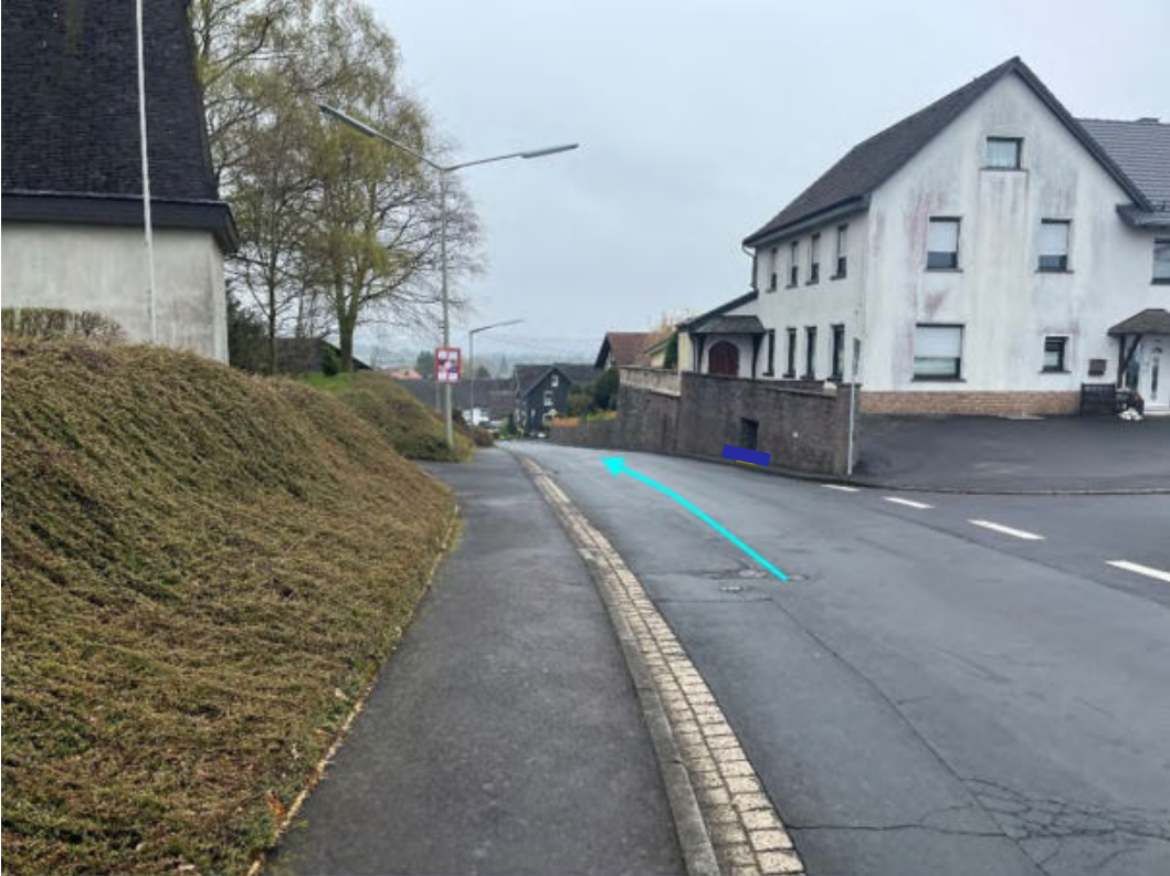
Abbildung 181: Notabflussweg "Hauptstraße" mit Fließrichtung (hellblau) und Objektschutzmaßnahmen (dunkelblau)
