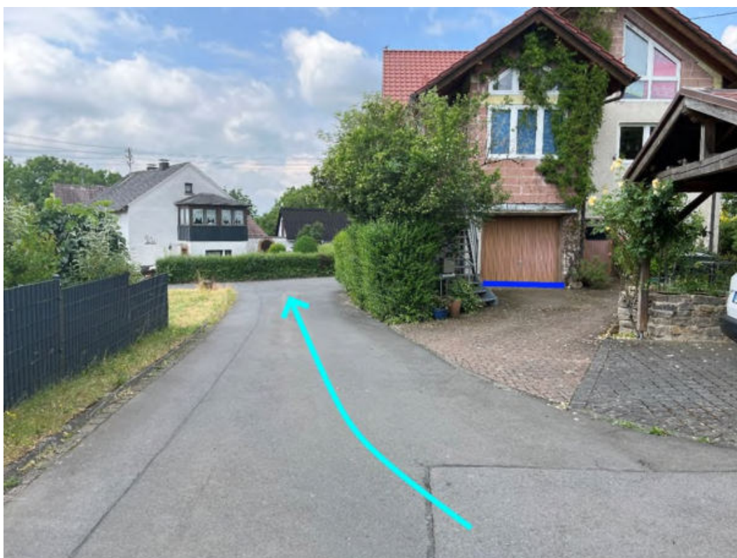
Abbildung 177: Notabflussweg "Hauptstraße" mit Fließrichtung (hellblau) und Objektschutzmaßnahmen (dunkelblau)
