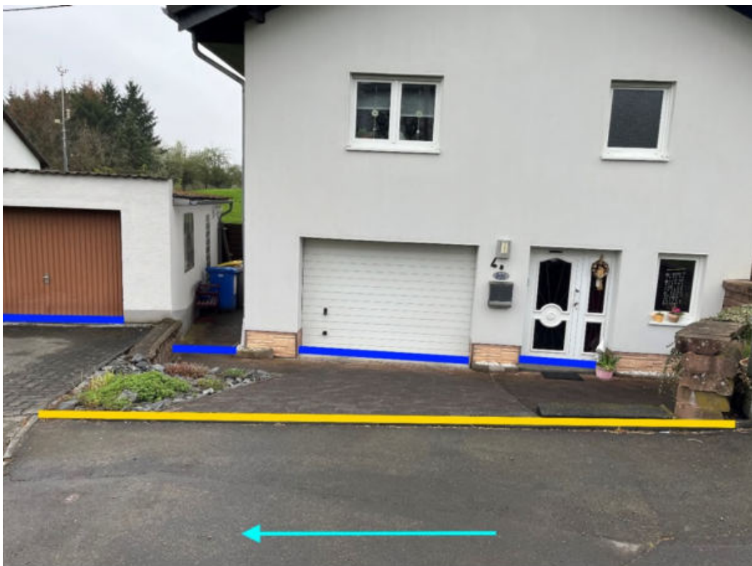
Abbildung 252: Notabflussweg "Limbacher Straße" mit Fließrichtung (hellblau), Objektschutzmaßnahmen (dunkelblau) und Bordanlagen (gelb)
