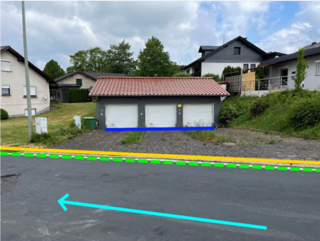
Abbildung 144: Notabflussweg "Hauptstraße" mit Fließrichtung (hellblau), Objektschutzmaßnahmen (dunkelblau), Entwässerungseinrichtung (hellgrün) und Bordanlagen (gelb)
