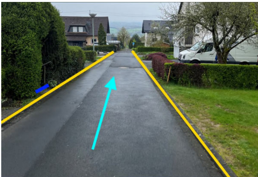
Abbildung 185: Notabflussweg "Rosenweg" mit Fließrichtung (hellblau), Objektschutzmaßnahmen (dunkelblau) und Bordanlagen (gelb)
