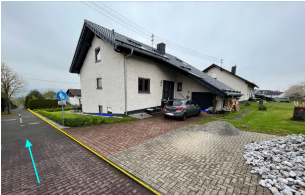
Abbildung 193: Notabflussweg "Rosenweg" mit Fließrichtung (hellblau), Objektschutzmaßnahmen (dunkelblau) und Bordanlagen (gelb)
