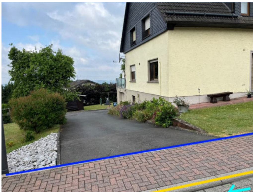
Abbildung 42: Notabflussweg „Bindweider Straße“ mit Fließrichtung (hellblau), Objektschutzmaßnahmen (dunkelblau) und Bordanlagen (gelb)
