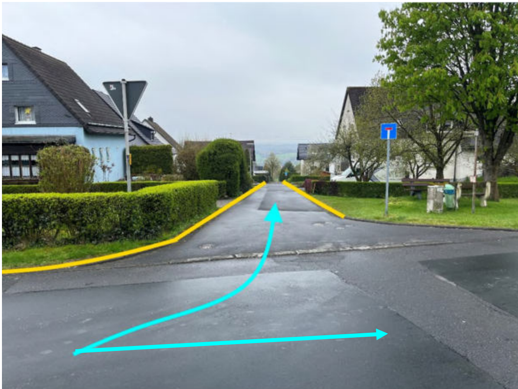
Abbildung 152: Notabflussweg "Hauptstraße" mit Fließrichtung (hellblau) und Bordanlagen (gelb)
