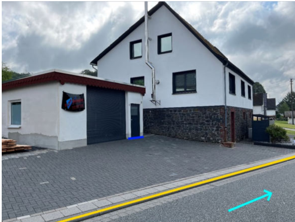
Abbildung 44: Notabflussweg „Bindweider Straße“ mit Fließrichtung (hellblau), Objektschutzmaßnahmen (dunkelblau) und Bordanlagen (gelb)
