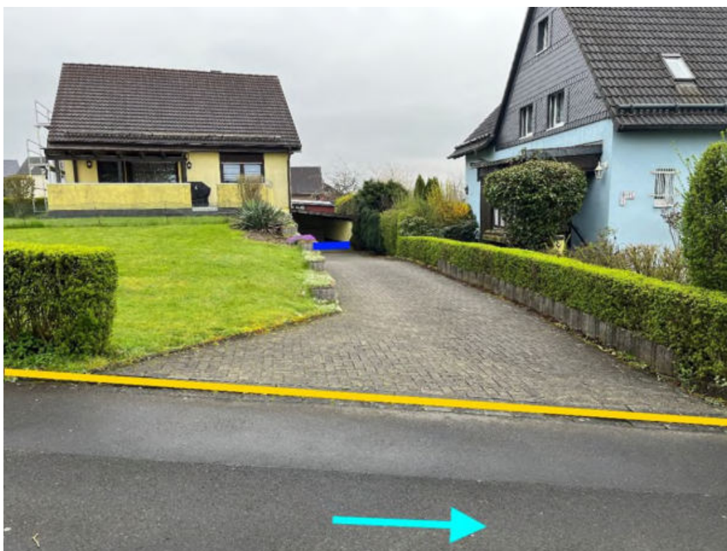
Abbildung 186: Notabflussweg "Rosenweg" mit Fließrichtung (hellblau), Objektschutzmaßnahmen (dunkelblau) und Bordanlagen (gelb)
