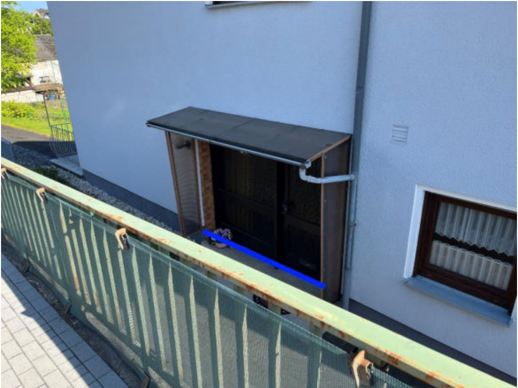
Abbildung 81: Notabflussweg "Hachenburger Straße" mit Objektschutzmaßnahmen (dunkelblau)
