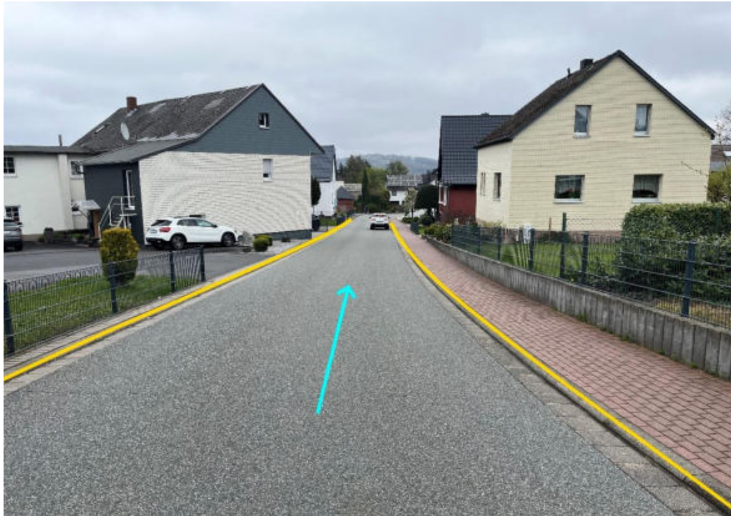
Abbildung 123: Notabflussweg "Liebergstraße" mit Fließrichtung (hellblau) und Bordanlagen (gelb)
