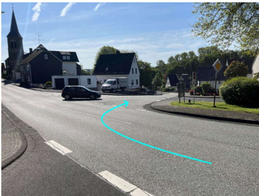
Abbildung 102: Notabflussweg "Hachenburger Straße" mit Fließrichtung (hellblau)
