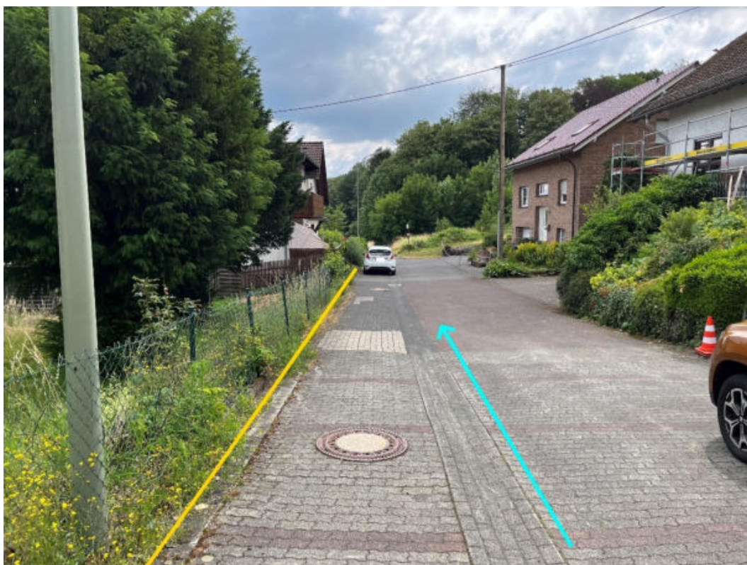
Abbildung 106: Notabflussweg "Steimelsgarten" mit Fließrichtung (hellblau) und Bordanlagen (gelb)
