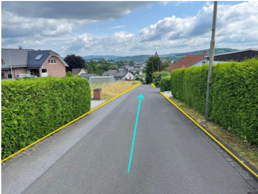
Abbildung 41: Notabflussweg "Tannenweg" mit Fließrichtung (hellblau) und Bordanlagen (gelb)
