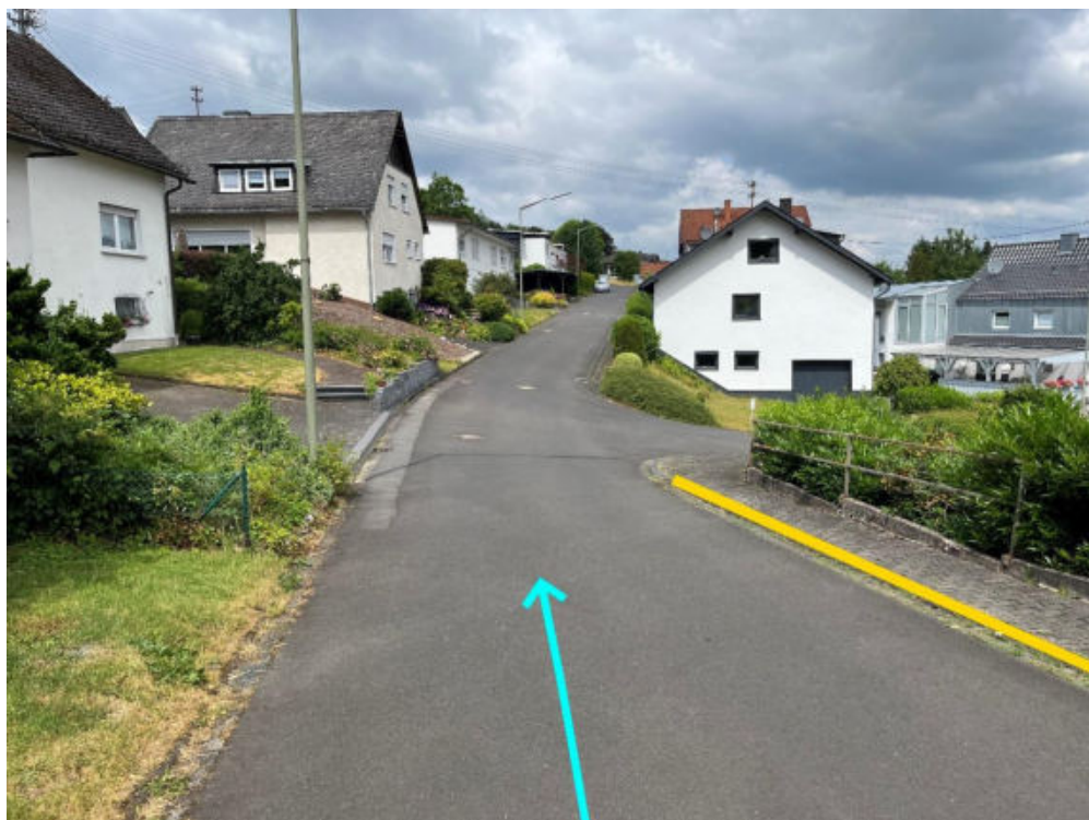
Abbildung 57: Notabflussweg "Tannenweg" mit Fließrichtung (hellblau) und Bordanlagen (gelb)
