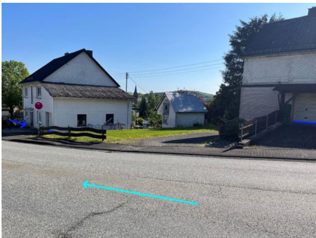
Abbildung 86: Notabflussweg "Hachenburger Straße" mit Fließrichtung (hellblau) und Objektschutzmaßnahmen (dunkelblau)
