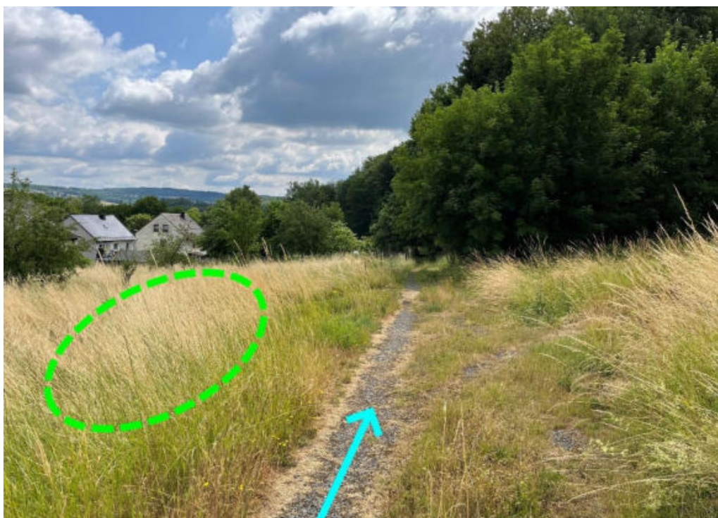
Abbildung 112: Notabflussweg "Steimelsgarten" mit Fließrichtung (hellblau) und mögliche Versickerungsfläche (grün)
