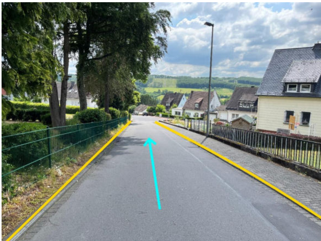
Abbildung 162: Notabflussweg "Schulstraße" mit Fließrichtung (hellblau) und Bordanlagen (gelb)
