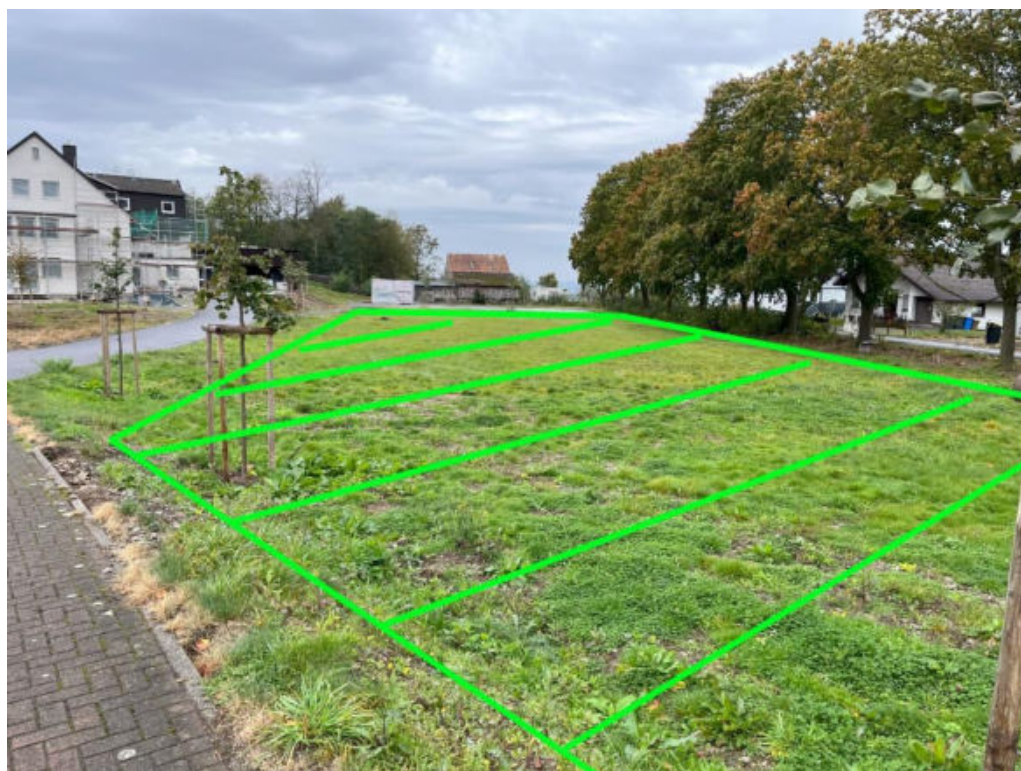
Abbildung 66: Notabflussweg "Hauptstraße" mit möglicher Retentionsfläche
