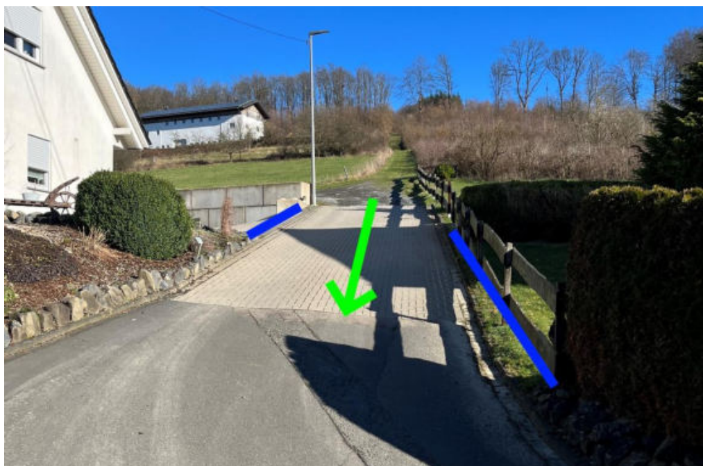
Abbildung 84: Notabflussweg „Petersberg“ mit Fließweg (grün), Objektschutzmaßnahmen (blau)
