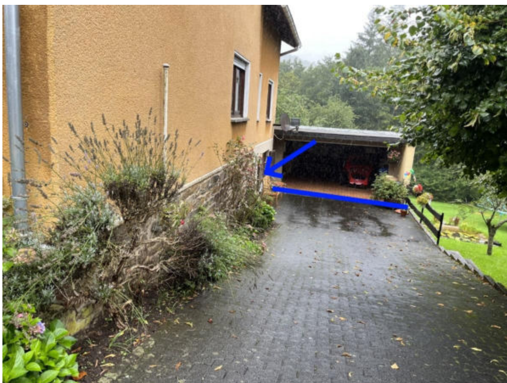
Abbildung 83: Notfließweg "Katzenwinkeler Straße" mit Objektschutzmaßnahmen (blau)
