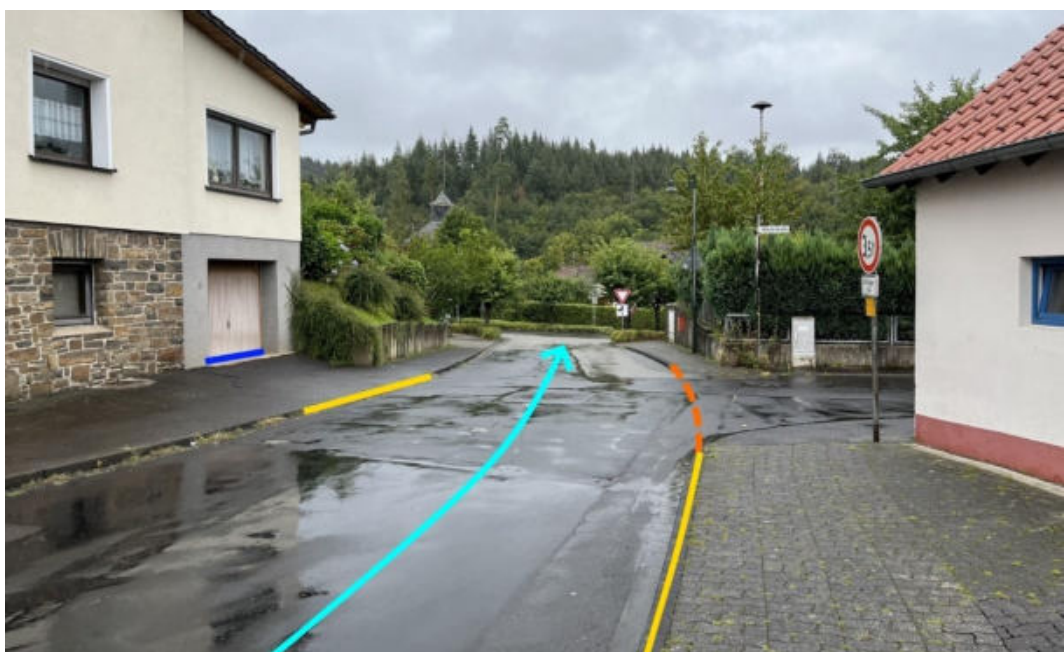
Abbildung 67: Notfließweg "Dorfstraße" mit Fließweg (hellblau), Objektschutzmaßnahmen (blau), Aufwallung (orange) und Bordanlagen (gelb)
