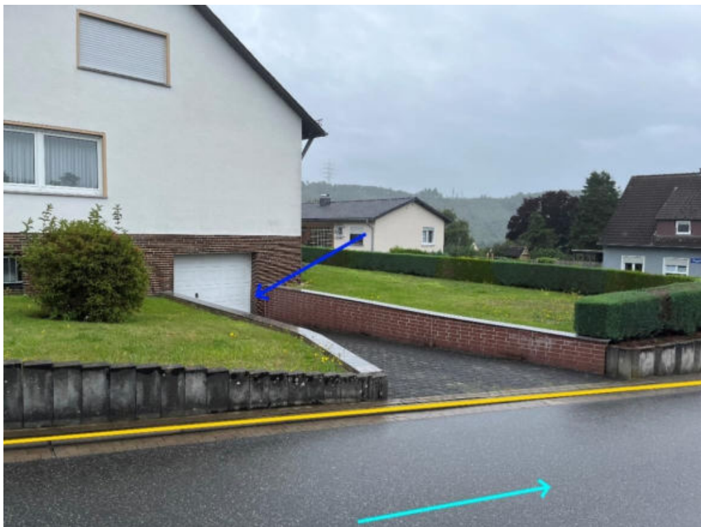
Abbildung 140: Notabflussweg "Gartenstraße" mit Fließrichtung (hellblau), Aufwattung (orange) und Bordanlagen (gelb)
