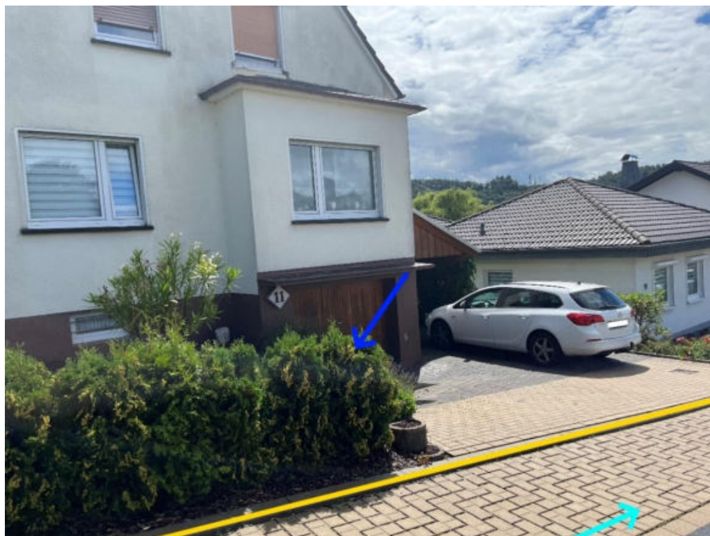
Abbildung 187: Notabflussweg "Brucher Straße" mit Fließrichtung (hellblau), Objektschutzmaßnahmen (blau) und Bordanlagen (gelb)
