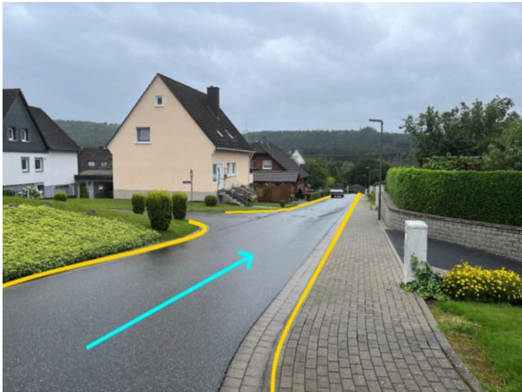
Abbildung 149: Notabflussweg "Gartenstraße" mit Fließrichtung (hellblau), Aufwällung (orange) und Bordanlagen (gelb)
