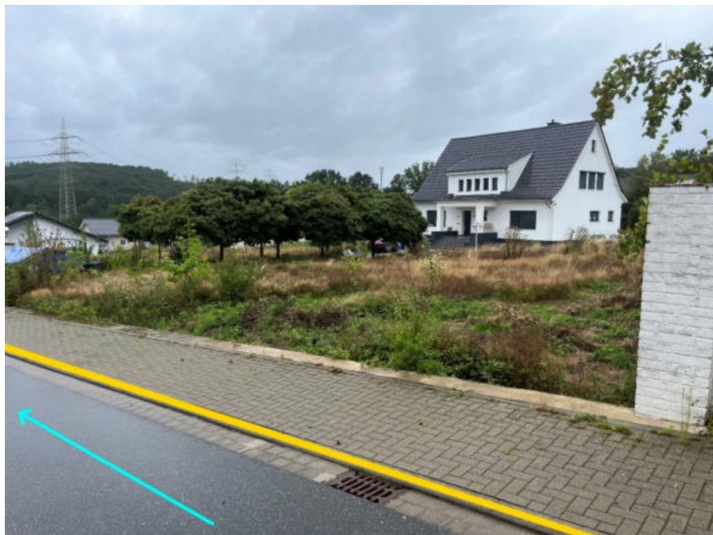
Abbildung 152: Notabflussweg "Gartenstraße" mit Fließrichtung (hellblau) und Bordanlagen (gelb)
