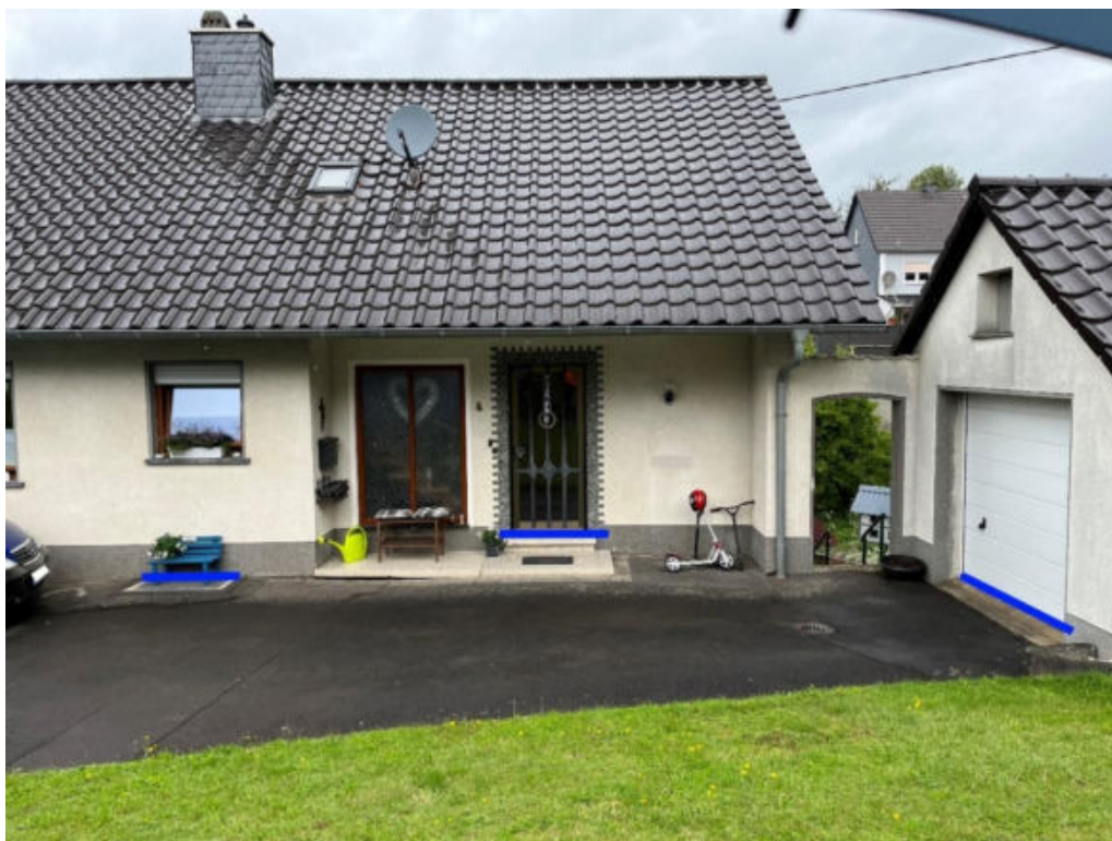
Abbildung 269: Notabflussweg "Schulstraße" mit Objektschutzmaßnahmen (blau)
