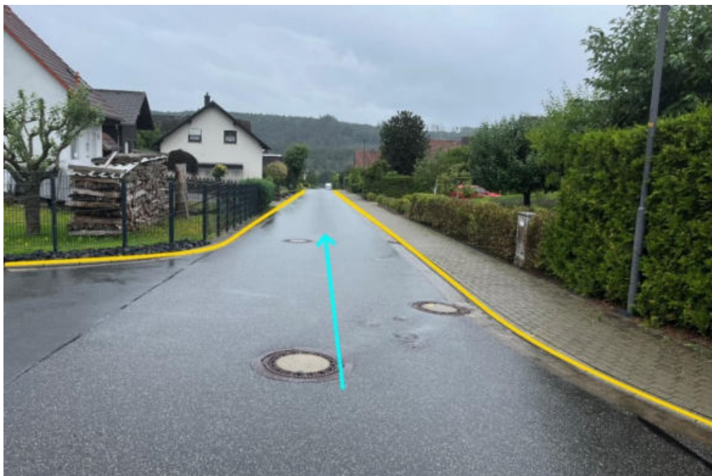
Abbildung 128: Notabflussweg "Gartenstraße" mit Fließrichtung (hellblau) und Bordanlagen (gelb)
