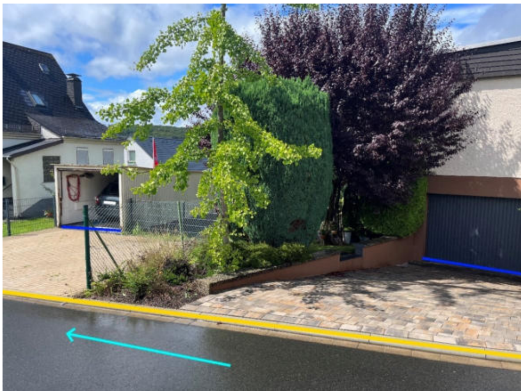
Abbildung 194: Notabflussweg "Brucher Straße" mit Fließrichtung (hellblau), Objektschutzmaßnahmen (blau) und Bordanlagen (gelb)
