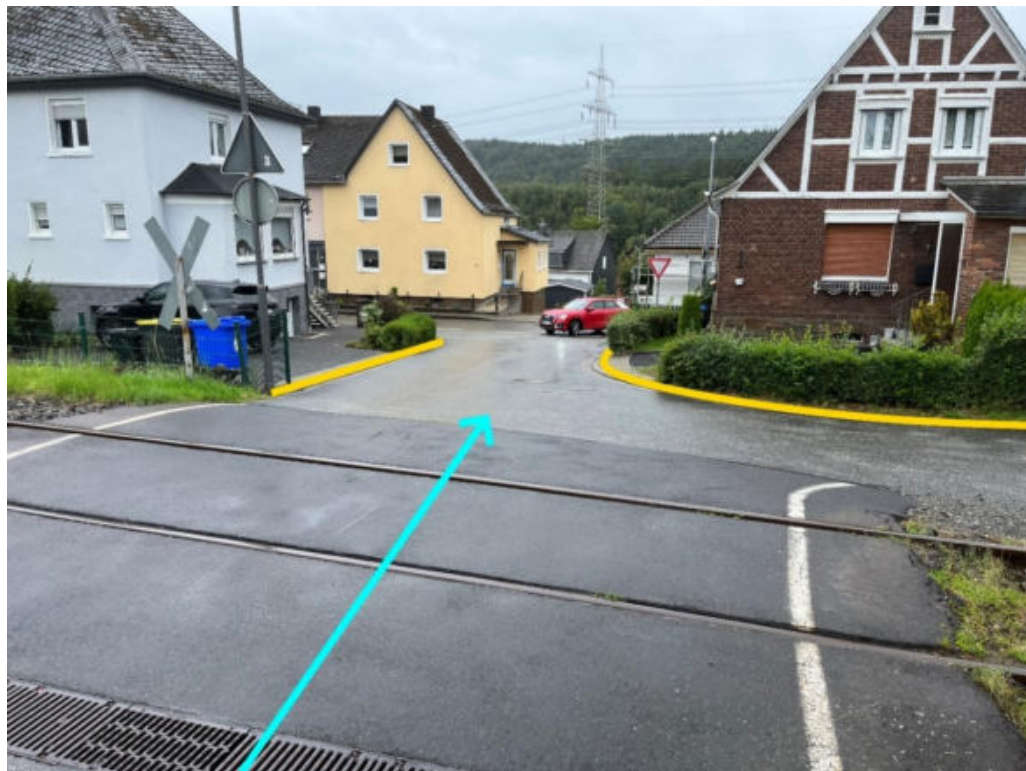
Abbildung 159: Notabflussweg "Gartenstraße" mit Fließrichtung (hellblau) und Bordanlagen (gelb)
