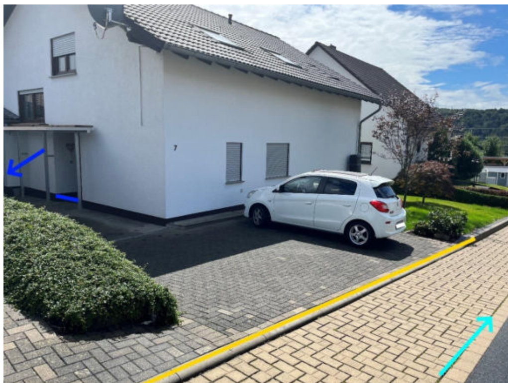
Abbildung 188: Notabflussweg "Brucher Straße" mit Fließrichtung (hellblau), Objektschutzmaßnahmen (blau) und Bordanlagen (gelb)
