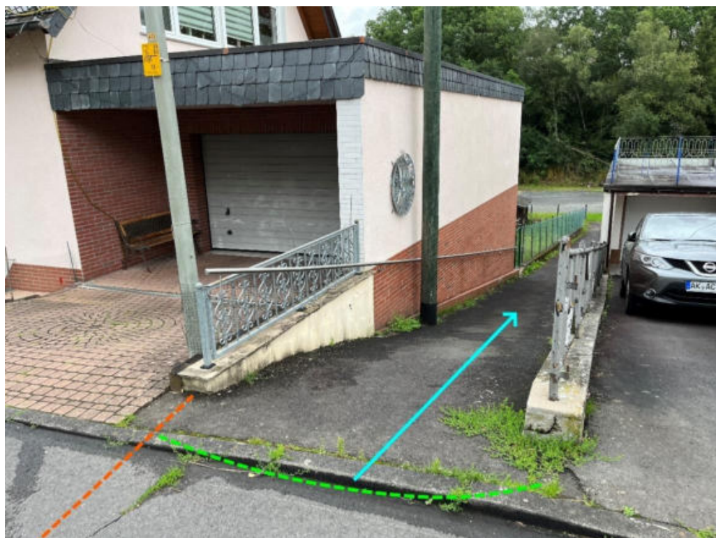
Abbildung 112: Notabflussweg "Hubertusweg" mit Fließrichtung (hellblau) und Aufwallung (orange)
