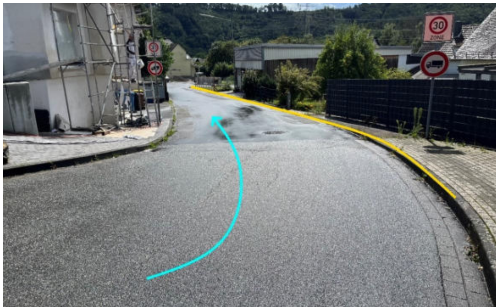
Abbildung 230: Notabflussweg "Josef-Barthel-Straße" mit Fließrichtung (hellblau) und Bordanlagen (gelb)
