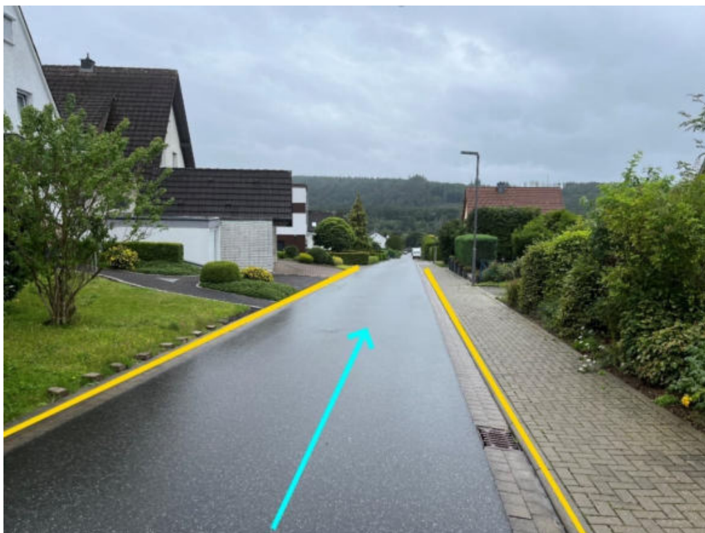
Abbildung 133: Notabflussweg "Gartenstraße" mit Fließrichtung (hellblau) und Bordanlagen (gelb)
