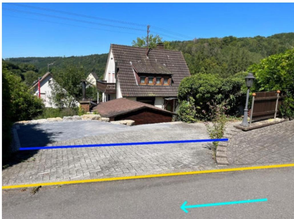
Abbildung 97: Notabflussweg "Am Brandhahn" mit Fließrichtung (hellblau), Bordanlagen (gelb) und Objektschutzmaßnahmen (blau)
