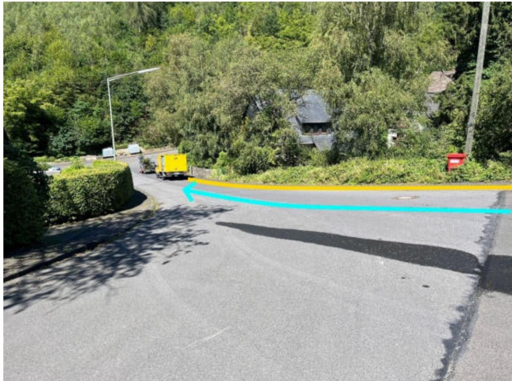
Abbildung 114: Notabflussweg "An der Brache" mit Fließrichtung (hellblau) und Bordanlagen (gelb)
