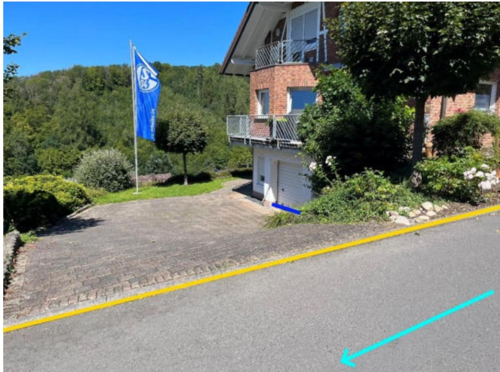
Abbildung 92: Notabflussweg "Am Brandhahn" mit Fließrichtung (hellblau), Bordanlagen (gelb) und Objektschutzmaßnahmen (blau)
