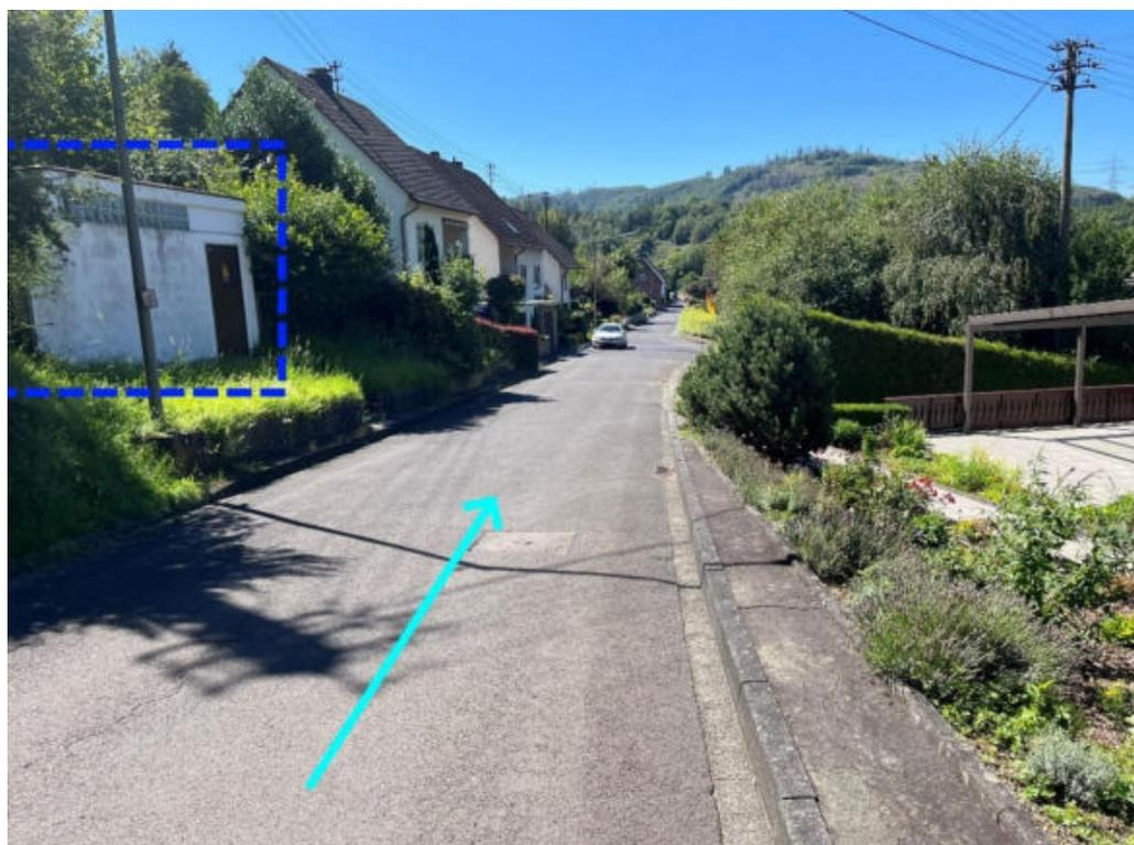
Abbildung 111: Notabflussweg "An der Brache" mit Fließrichtung (hellblau) und Objektschutzmaßnahmen (blau)
