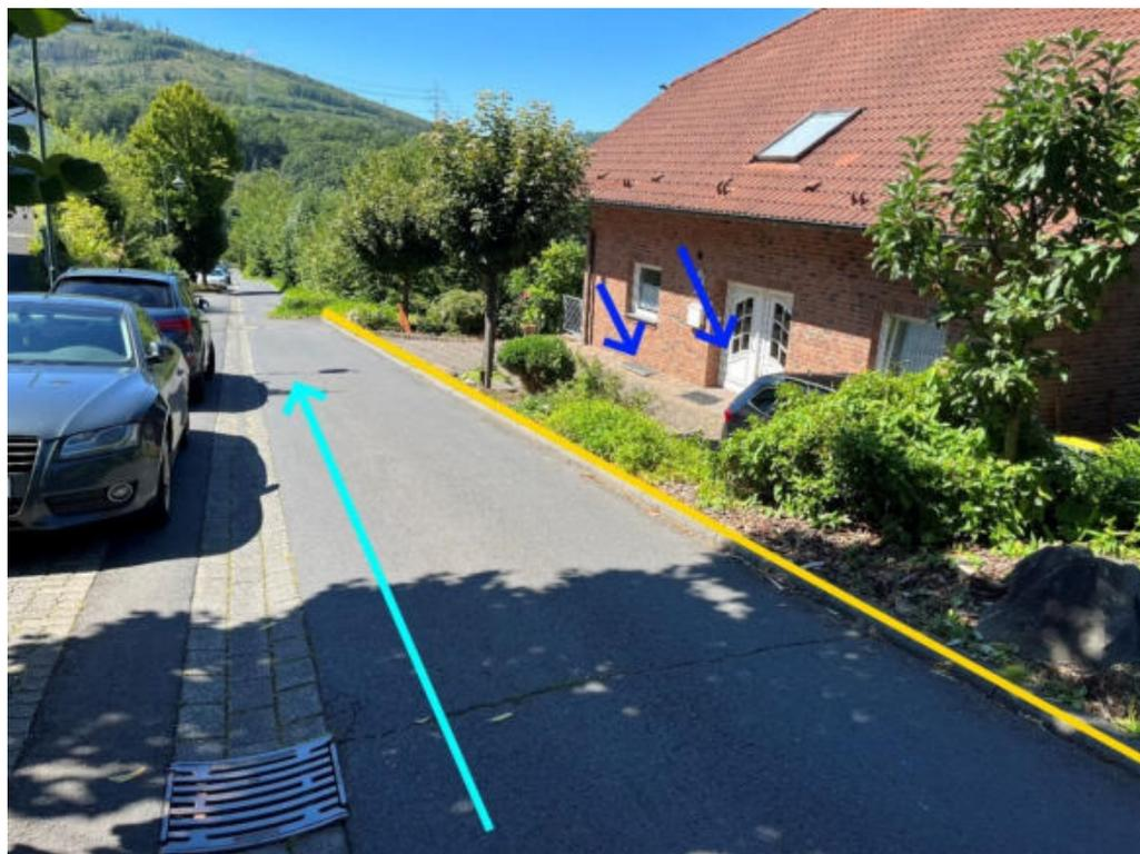
Abbildung 90: Notabflussweg "Am Brandhahn" mit Fließrichtung (hellblau), Bordanlagen (gelb) und Objektschutzmaßnahmen (blau)
