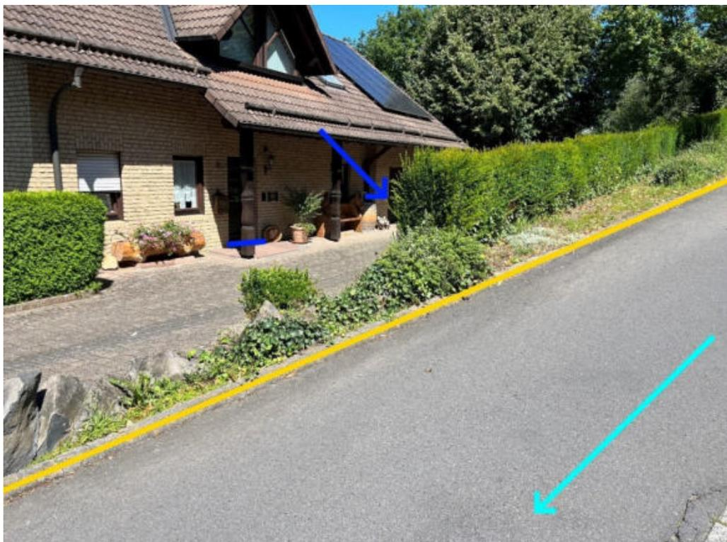
Abbildung 89: Notabflussweg "Am Brandhahn" mit Fließrichtung (hellblau), Bordanlagen (gelb) und Objektschutzmaßnahmen (blau)
