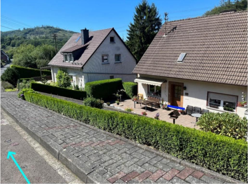
Abbildung 109: Notabflussweg "An der Brache" mit Fließrichtung (hellblau) und Objektschutzmaßnahmen (blau)
