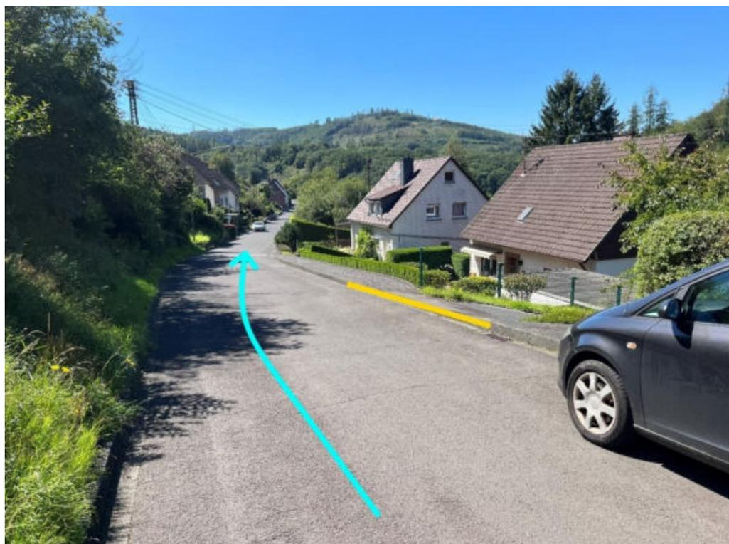
Abbildung 107: Notabflussweg "An der Brache" mit Fließrichtung (hellblau) und Bordanlagen (gelb)
