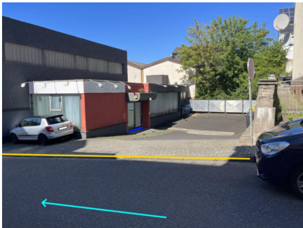
Abbildung 534: Notabflussweg „Schulstraße“ mit Fließweg (hellblau), Objektschutzmaßnahmen (blau) und Bordanlage (gelb)
