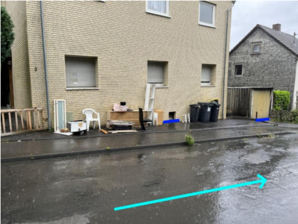
Abbildung 84: Notabflussweg "Friedrich-Ebert-Straße" mit Fließweg (hellblau) und Objektschutzmaßnahmen (blau)
