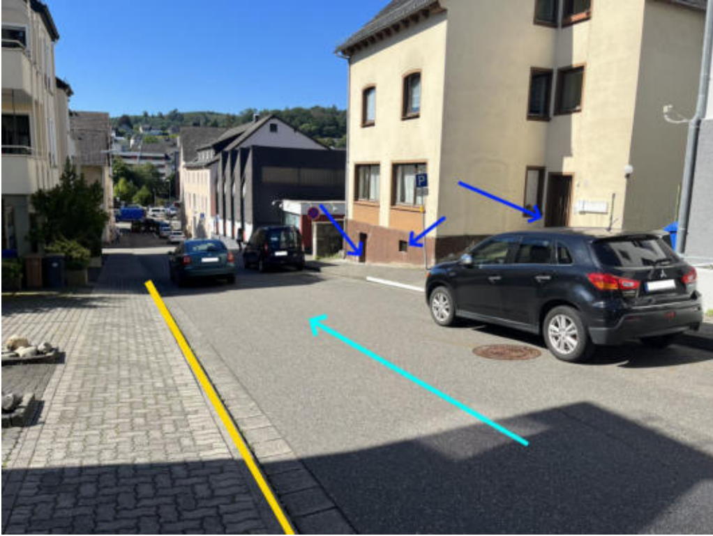
Abbildung 533: Notabflussweg „Schulstraße“ mit Fließweg (hellblau), Objektschutzmaßnahmen (blau) und Bordanlage (gelb)
