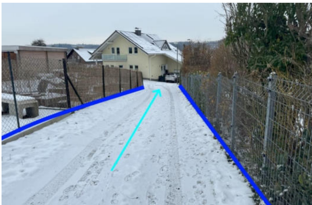
Abbildung 265: Notabflussweg „Erlenweg“ mit Fließweg (hellblau) und Objektschutzmaßnahmen (blau)
