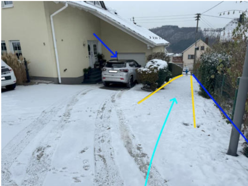
Abbildung 266: Notabflussweg „Erlenweg“ mit Fließweg (hellblau) und Objektschutzmaßnahmen (blau)
