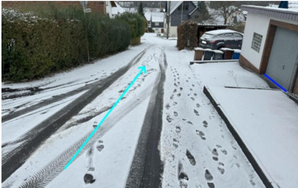
Abbildung 336: Notabflussweg „Kurze Straße“ mit Fließweg (hellblau) und Objektschutzmaßnahmen (blau)
