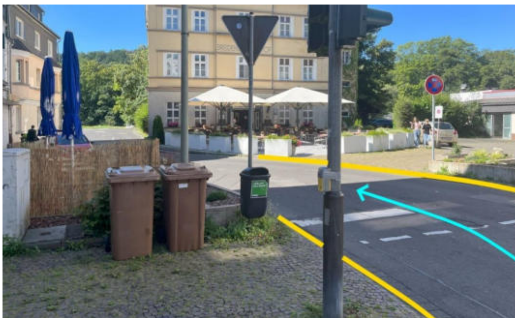
Abbildung 503: Notabflussweg „Klosterhof“ mit Fließweg (hellblau) und Bordanlage (gelb)
