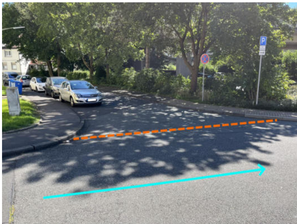
Abbildung 518: Notabflussweg „Bergstraße“ mit Fließweg (hellblau) und Aufwallung (orange)
