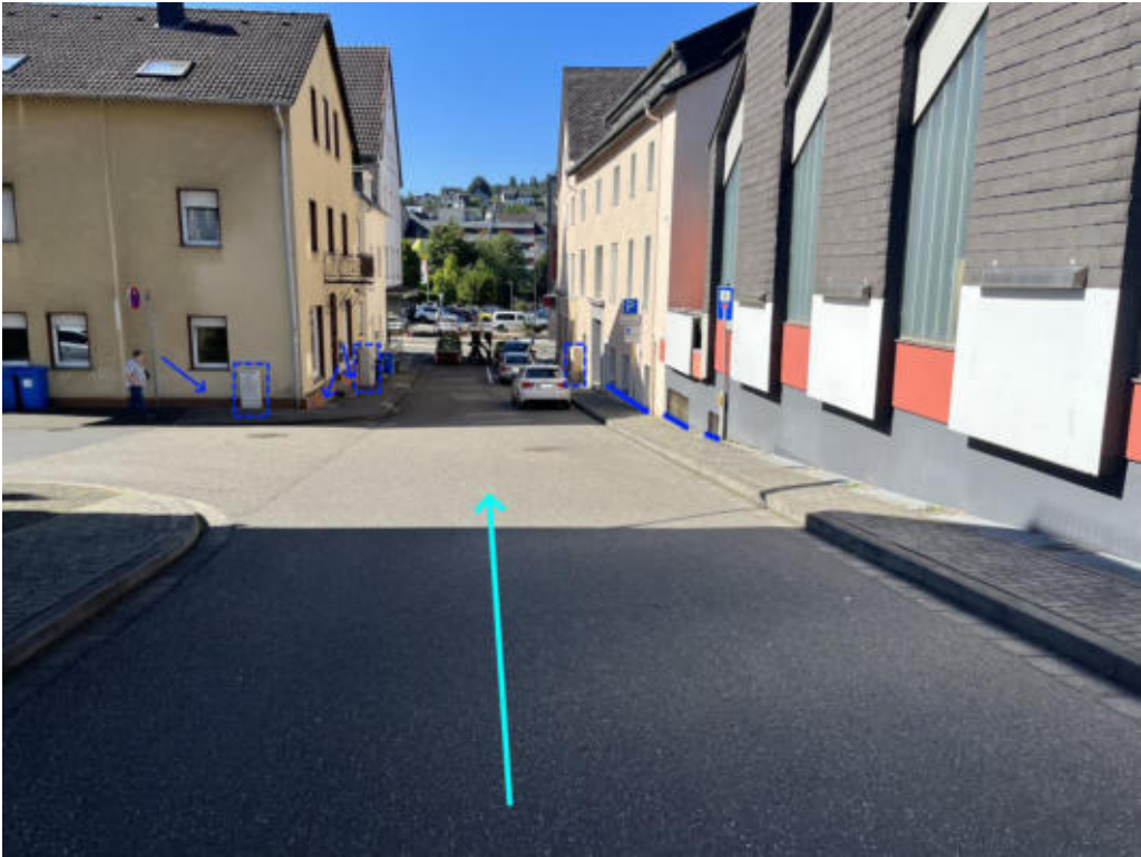
Abbildung 536: Notabflussweg „Schulstraße“ mit Fließweg (hellblau) und Objektschutzmaßnahmen (blau)
