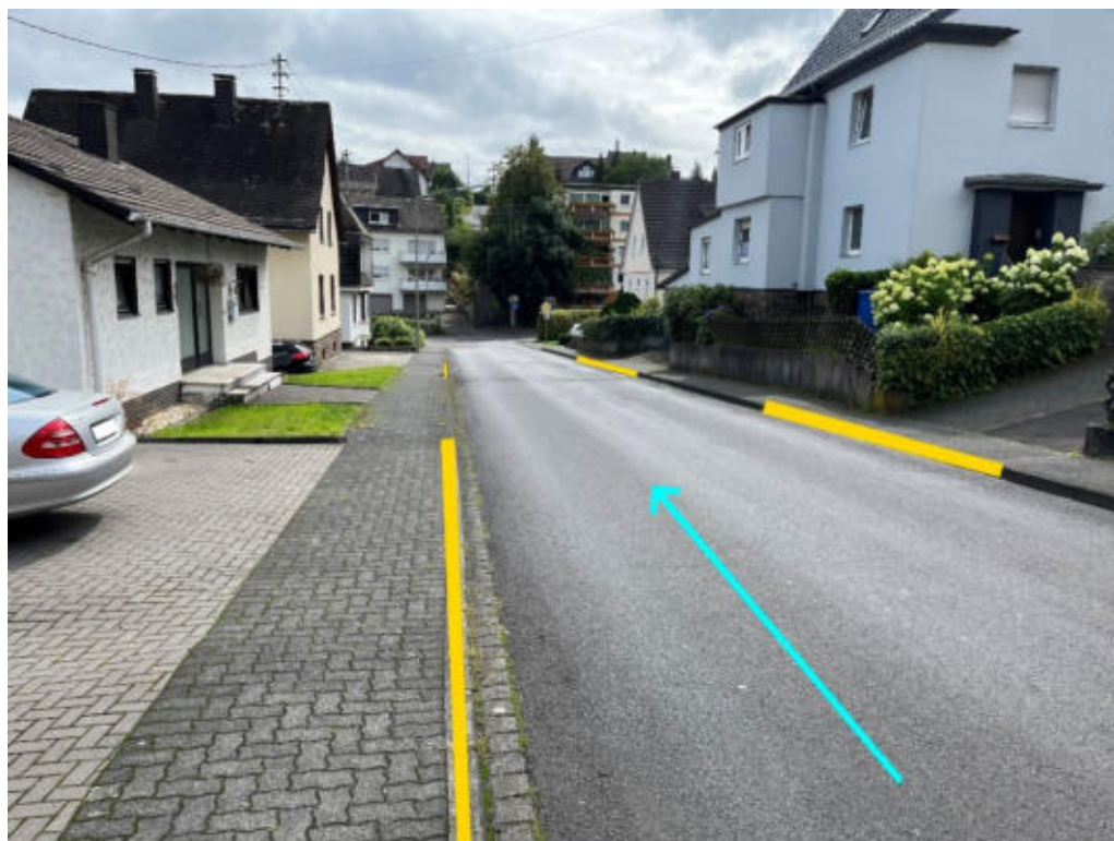
Abbildung 158: Notabflussweg "Mühlenweg" mit Fließweg (hellblau) und Bordanlage (gelb)
