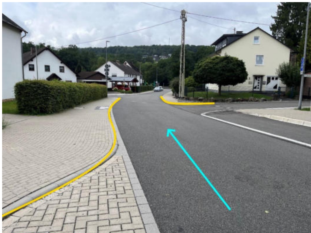
Abbildung 231: Notabflussweg „Geschwister-Scholl-Straße“ mit Fließweg (hellblau) und Bordanlage (gelb)
