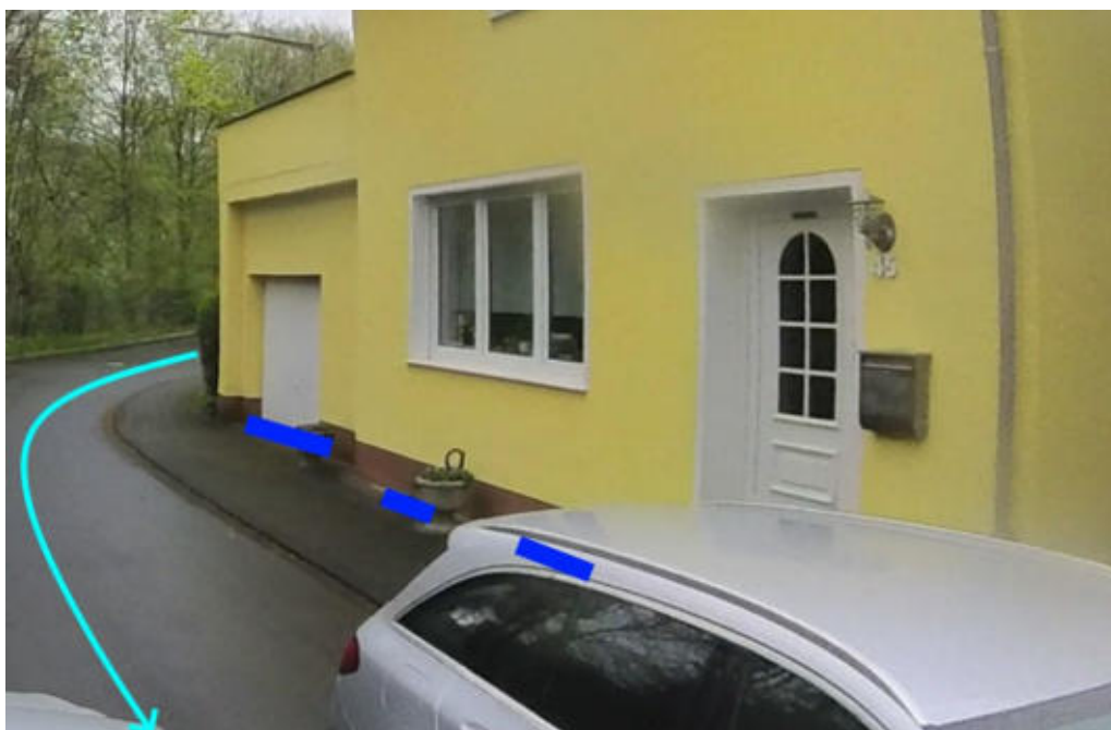
Abbildung 692: Notabflussweg „Eisenbahnstraße“ mit Fließweg (hellblau) und Objektschutzmaßnahmen (blau)
