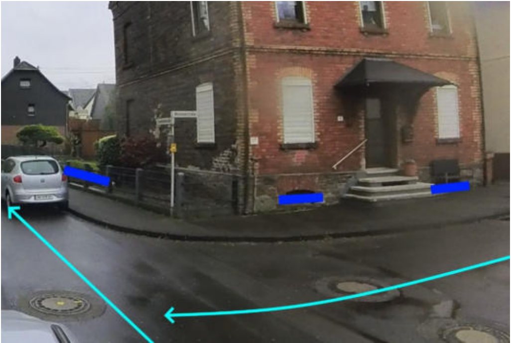
Abbildung 687: Notabflussweg „Eisenbahnstraße“ mit Fließweg (hellblau) und Objektschutzmaßnahmen (blau)
