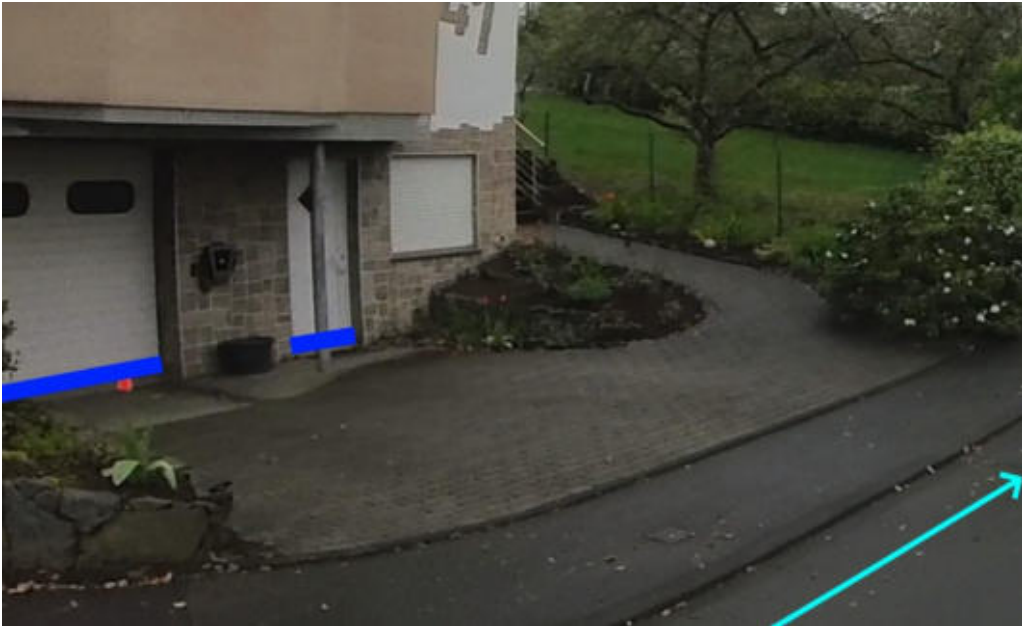
Abbildung 749: Notabflussweg „Ketteler Straße“ mit Fließweg (hellblau) und Objektschutzmaßnahmen (blau)
