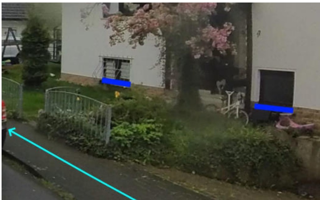
Abbildung 683: Notabflussweg „Eisenbahnstraße“ mit Fließweg (hellblau) und Objektschutzmaßnahmen (blau)
