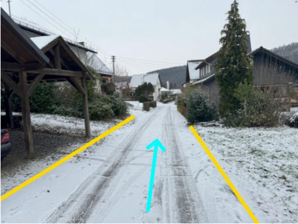
Abbildung 301: Notabflussweg „Helenenweg“ mit Fließweg (hellblau) und Bordanlage (gelb)
