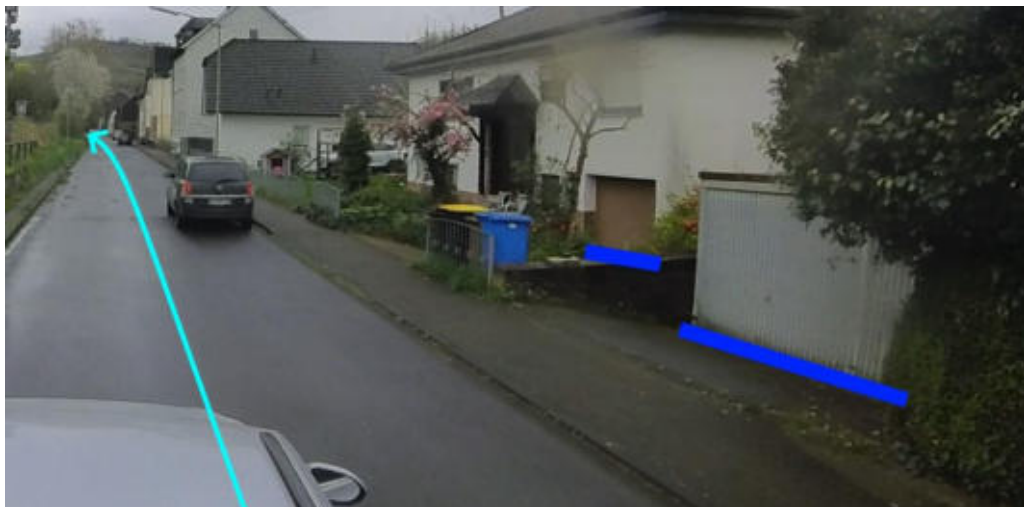
Abbildung 682: Notabflussweg „Eisenbahnstraße“ mit Fließweg (hellblau) und Objektschutzmaßnahmen (blau)
