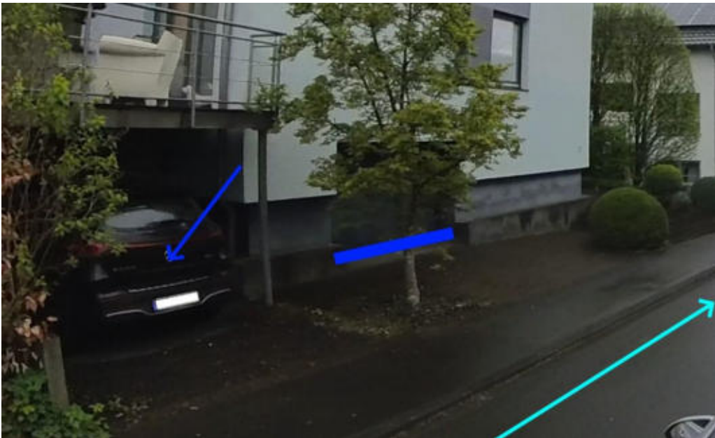
Abbildung 750: Notabflussweg „Ketteler Straße“ mit Fließweg (hellblau) und Objektschutzmaßnahmen (blau)
