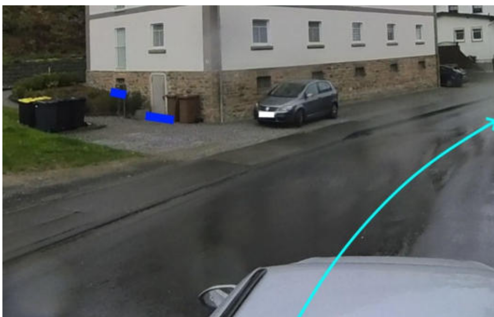
Abbildung 698: Notabflussweg „Gäulenwaldstraße“ mit Fließweg (hellblau) und Objektschutzmaßnahmen (blau)
