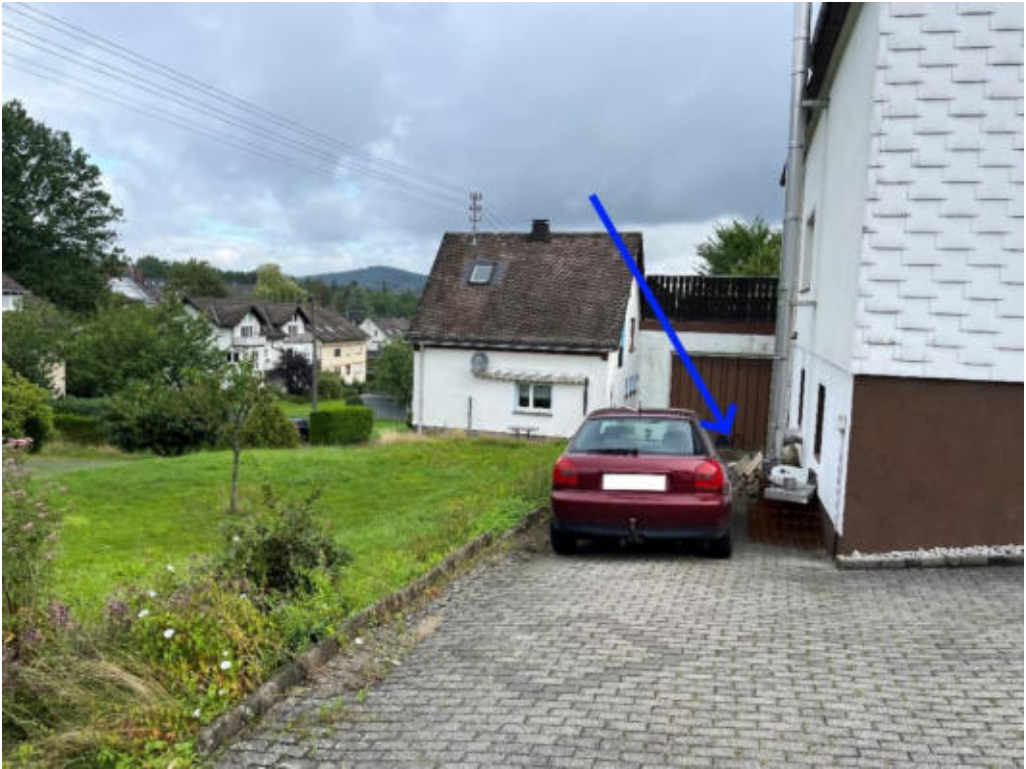
Abbildung 114: Notabflussweg "Schwalbenweg" mit Objektschutzmaßnahmen (blau)
