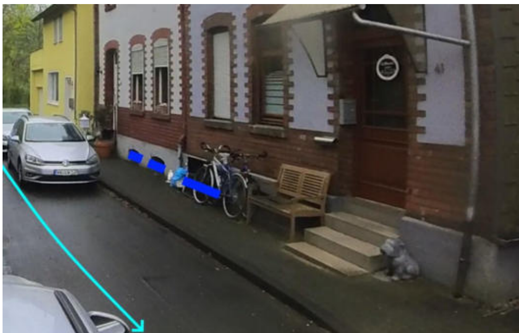
Abbildung 691: Notabflussweg „Eisenbahnstraße“ mit Fließweg (hellblau) und Objektschutzmaßnahmen (blau)
