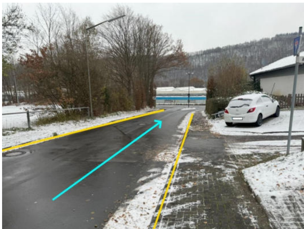
Abbildung 377: Notabflussweg „Theresenstraße“ mit Fließweg (hellblau) und Bordanlage (gelb)
