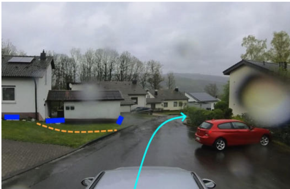
Abbildung 779: Notabflussweg „Nikolaus-Ehlen-Straße“ mit Fließweg (hellblau), Aufwallung (orange) und Objektschutzmaßnahmen (blau)
