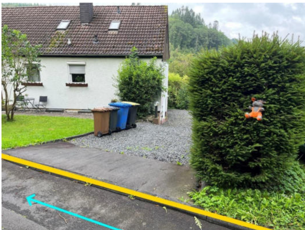
Abbildung 107: Notabflussweg "Zum Eisweiher" mit Fließweg (hellblau) und Bordanlage (gelb)
