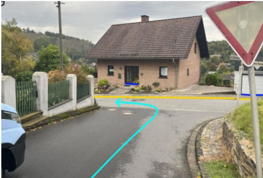
Abbildung 115: Notabflussweg "Im Heidchesgarten" mit Fließrichtung (hellblau), Bordanlagen (gelb) und Objektschutzmaßnahmen (blau)
