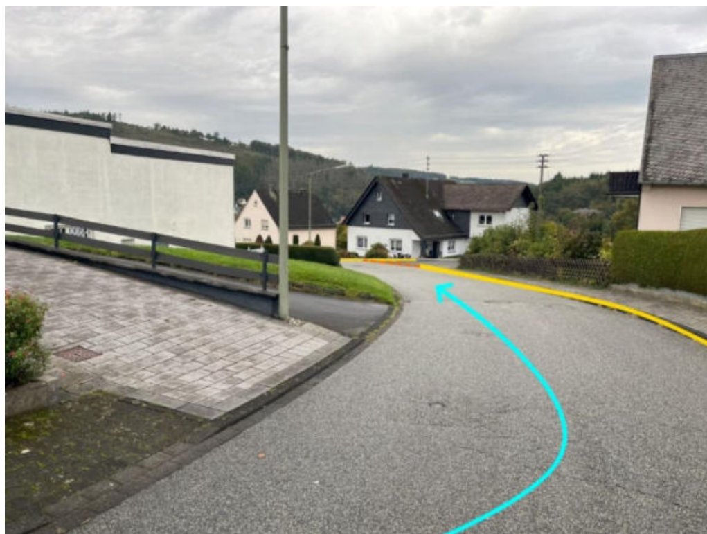
Abbildung 123: Notabflussweg "Schutzbacher Weg" mit Fließrichtung (hellblau), Bordanlagen (gelb) und Objektschutzmaßnahmen (blau)
