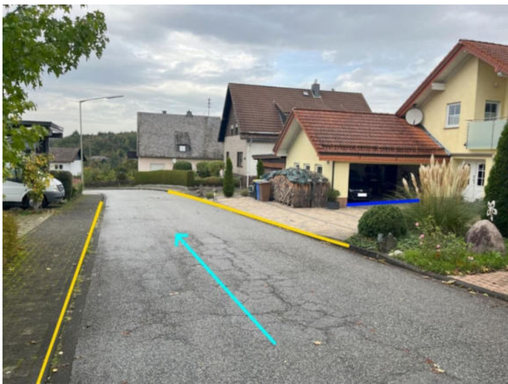
Abbildung 120: Notabflussweg "Schutzbacher Weg" mit Fließrichtung (hellblau), Bordanlagen (gelb) und Objektschutzmaßnahmen (blau)
