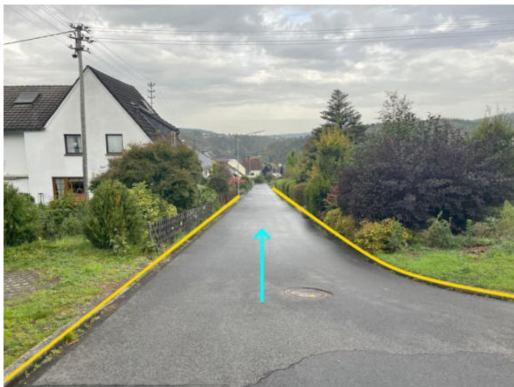
Abbildung 155: Notabflussweg "Dorfwiese" mit Fließrichtung (hellblau) und Bordanlagen (gelb)
