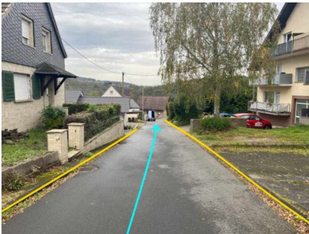
Abbildung 111: Notabflussweg "Im Heidchesgarten" mit Fließrichtung (hellblau), Bordanlagen (gelb) und Objektschutzmaßnahmen (blau)
