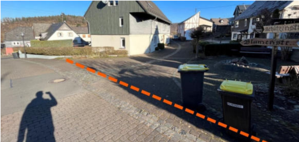
Abbildung 94: Notabflussweg "Schützenstraße" mit Aufwallung (orange)
