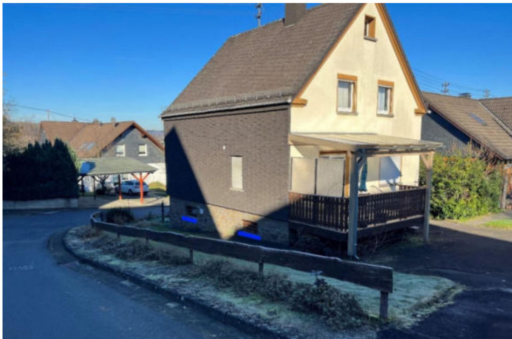
Abbildung 74: Notabflussweg "Weiherstraße" mit Objektschutzmaßnahmen (blau)
