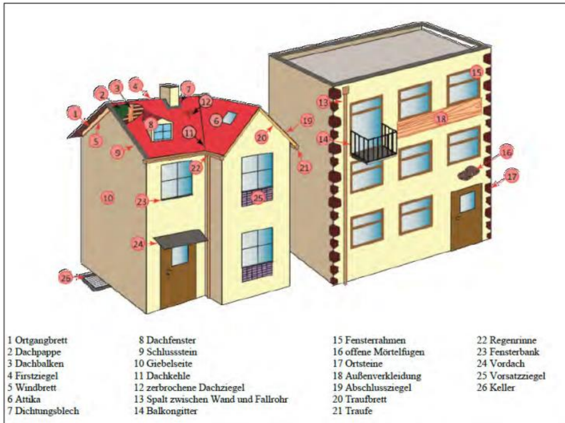
Abbildung 18: Potenzielle Nist- und Schlafplätze von Vögeln und Fledermäusen an Gebäuden 6) .
